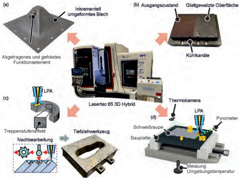
Bild 1: (a) Aufbringen der Funktionselemente auf inkrementell umgeformte Bleche, (b) Herstellung der Werkzeuge für das Presshärten, (c) Prozessroute des hybriden additiven Schichtlaminierverfahrens und des Tiefziehwerkzeugs, (d) Modellierung des LPA-Prozesses mit der „Particle Finite Element Method“
