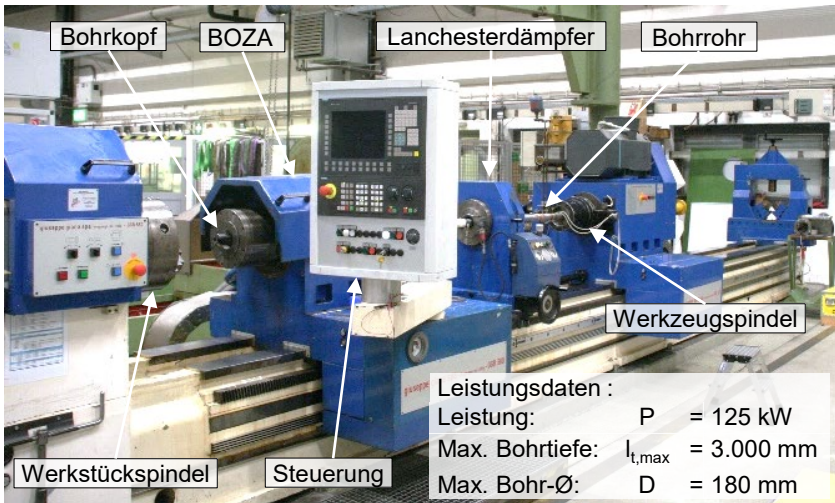
Abbildung 4.2.: Die Versuchsmaschine Giana GGB 560 CNC
