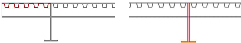
Abb. 3.12: Prinzipdarstellung des betrachteten Plattenüberstands auf der Unterseite (l.) und des Hauptträgers (r.) (nach [25])
