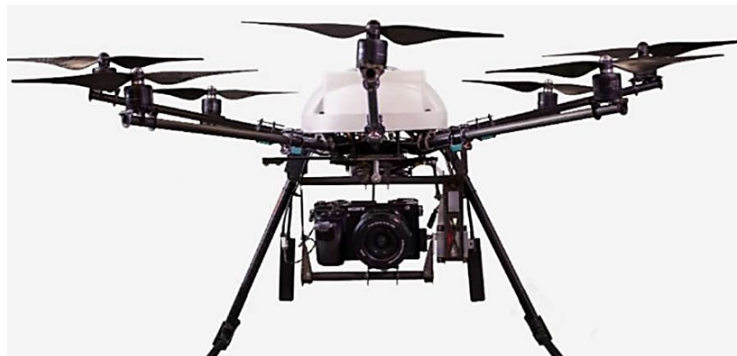
Abb. 2.16: Beispiel für ein Inspektions-UAS [53]
