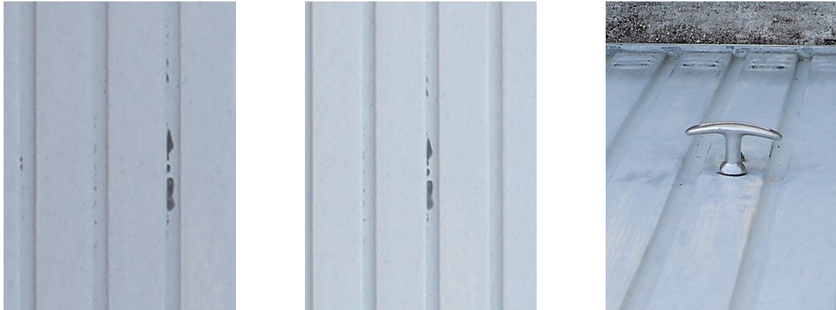
Abb. 3.7: l.: Testmotiv fotografiert mit 50 mm-Objektiv aus 10 m Entfernung ([25], S. 33) m.: Testmotiv fotografiert mit 70 mm-Objektiv aus 15 m Entfernung und Vergrößerung ([25], S. 35) r.: Testmotiv fotografiert mit 50 mm-Objektiv aus 10 m Entfernung ([25], S. 36)
