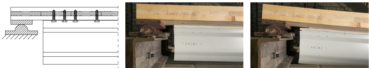
Bild 4.42: Auflagersituation, Ausgangs- und Endzustand für B-HS12-90-01H
