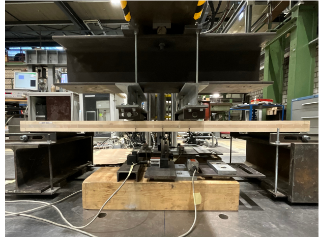
Bild 4.4: Schematischer Aufbau der BSP-Biegeversuche und Probekörper im Versuchsstand
