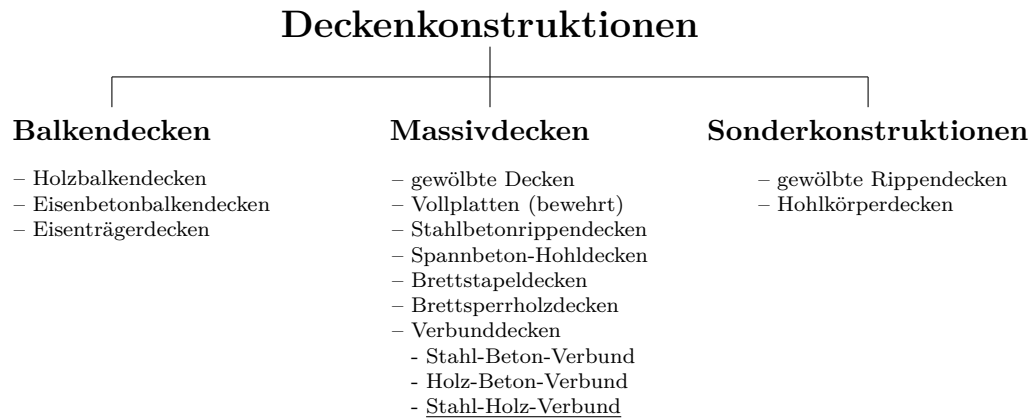
Bild 2.1: Übersicht typischer Deckenkonstruktionen in Anlehnung an [1]
