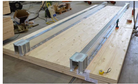
Bild 2.5: Verbundsystem und Probekörper mit Z-Profilen und Brettsper Holzplatte [157]
