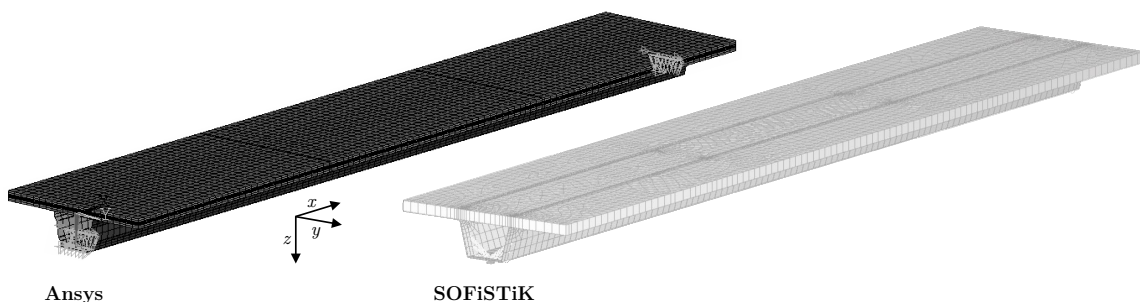
Bild 5.11: Finite-Elemente-Modelle für die aufgestellte Lagerung auf dem STP
