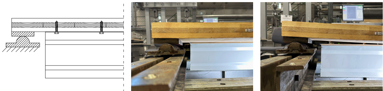
Bild 4.32: Auflagersituation und lokales Versagen des Vorversuches B-HS10-90-01H
