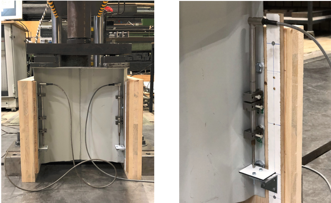
Bild 4.10: Probekörper im Versuchsstand und Positionierung der Wegaufnehmer
