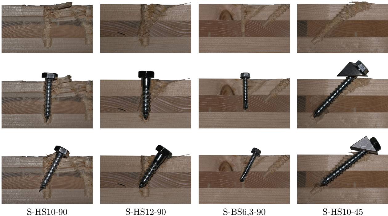
Bild 4.20: Lochleibung der BSP-Platte für die untersuchten Versuchsreihen
