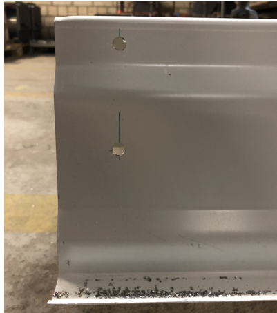
Bild C.12: Bohrungen für Auflagerschott
