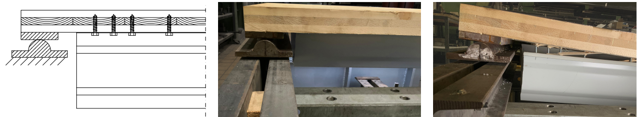
Bild 4.39: Auflagersituation, Ausgangs- und Endzustand für B-HS10-90-03H
