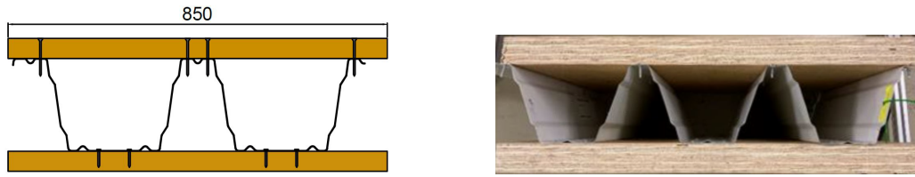
Bild 2.10: Verbundsystem und Probekörper aus Holz-Stahl-Hybridelementen [209, 218]
