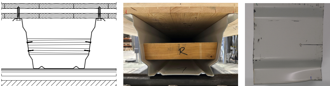
Bild 4.31: Auflagersituation und lokales Versagen des Vorversuches B-HS10-90-01
