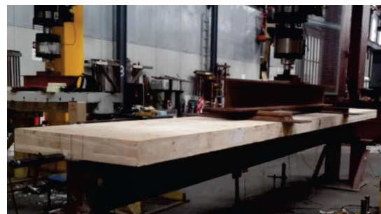
Bild 2.6: Verbundsystem und Probekörper mit Walzprofil und Brettsper Holzplatte [117]
