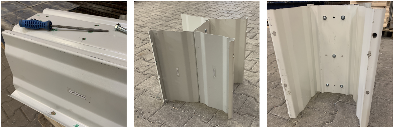
Bild C.8: Verbundene STP und aufgeweitete Löcher für die um 45° geneigten Schrauben
