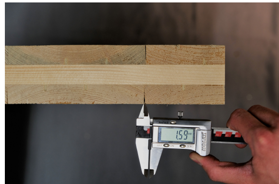
Bild C.2: Gemessener Fugenspalt außen
