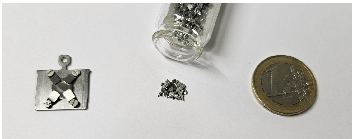
Abbildung 4.1: Verwendeter Ag(110)-Einkristall montiert auf einem Probenhalter (links) sowie Antimongranulat (mittig), welches verdampft wird. Als Größenvergleich dient eine 1-Euro-Münze.
