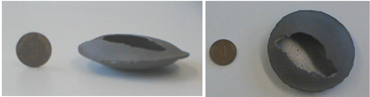
Abbildung 4.1-3: Geöffnete Testpore nach mehreren Nitrierzyklen in einem technischen Nitrierofen; ein Pfennigstück dient zum Grössenvergleich
