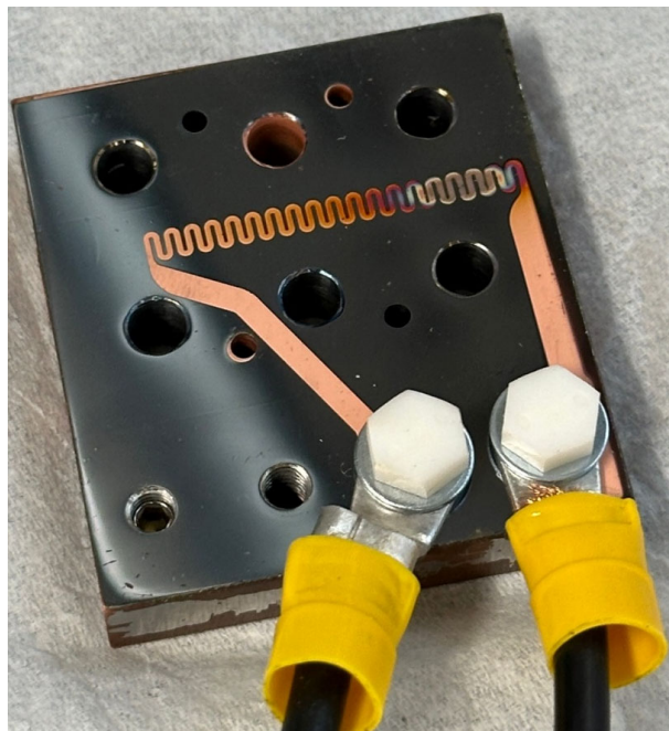
Abbildung 10: Verschraubung von Kontakten auf einem Edelstahl-Hotend mit Keramikschrauben
