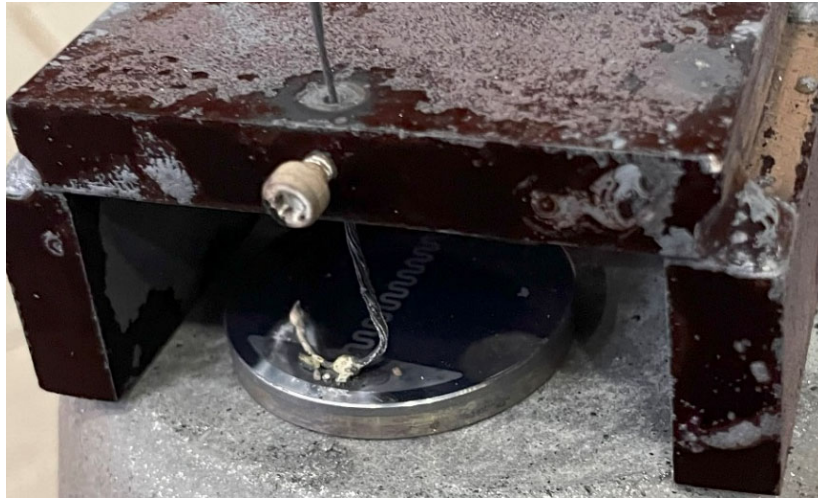
Abbildung 13: In einem Ofen hergestellte, spröde Hartlötverbindung zwischen einem Kabel und einem beschichteten Rundsubstrat.
