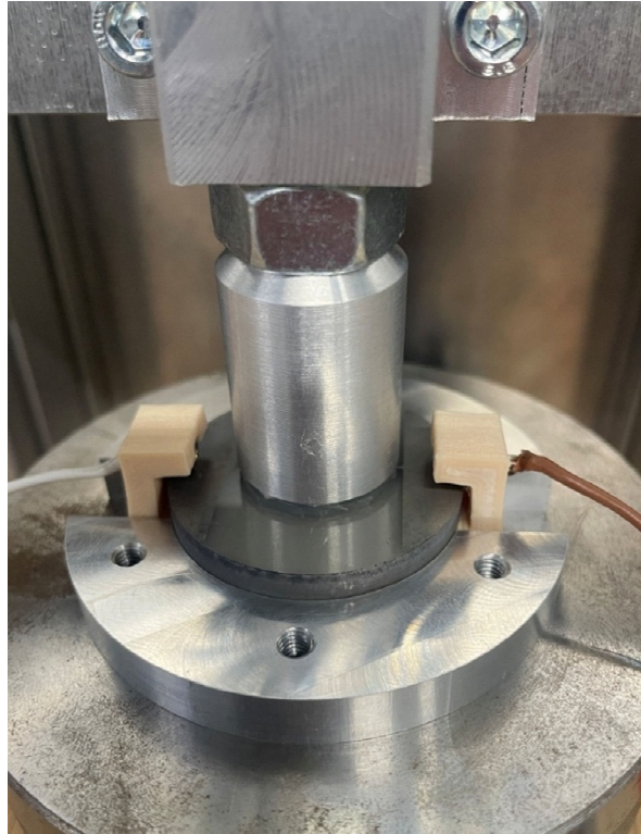
Abbildung 43: Versuchsaufbau zur mechanischen Druckprüfung auf beschichteten Wendeln
