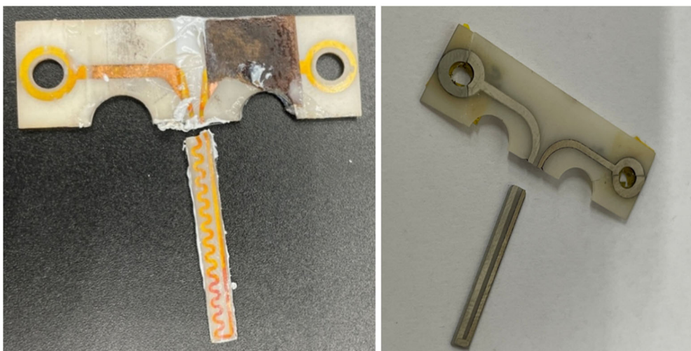
Abbildung 8: Gebrochenes T-Stück mit angehaftetem Kunststoff (PLA) entlang des Heißkanals und verkohltem Dichtungspapier auf der rechten Schulter (links) und mehrfach gebrochenes T-Stück mit beschichtetem Thermoelement
