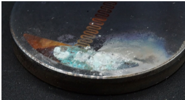
Abbildung 12: Lötstelle auf einem Edelstahlrundsubstrat, deutlich wird, dass durch den Lötversuch die Funktionsschicht angegriffen wird und das Kabel nicht auf der Kontaktfläche haftet
