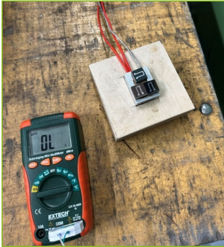
Abbildung 36: Aufzeichnen der Temperatur mit Thermoelementen auf drei verschiedenen Substratmaterialien
