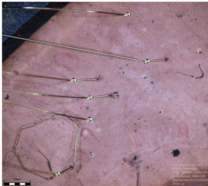
Abbildung 15: Hergestellte Bonding-Verbindung mit Gold-Drähten auf einer PVD-Kupferschicht
