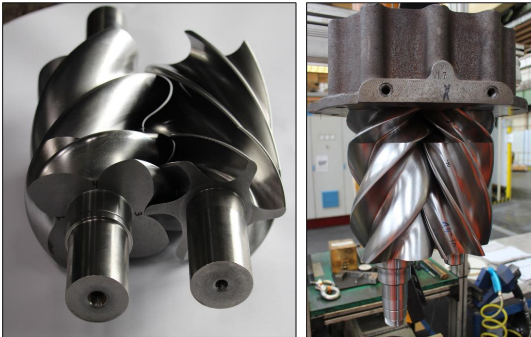
Abbildung 8.5: Dual-Lead-Rotorpaar aus Stahl vor Bearbeitung der Wellenabsätze (links) und vor der Montage in das Läufergehäuse (rechts).
