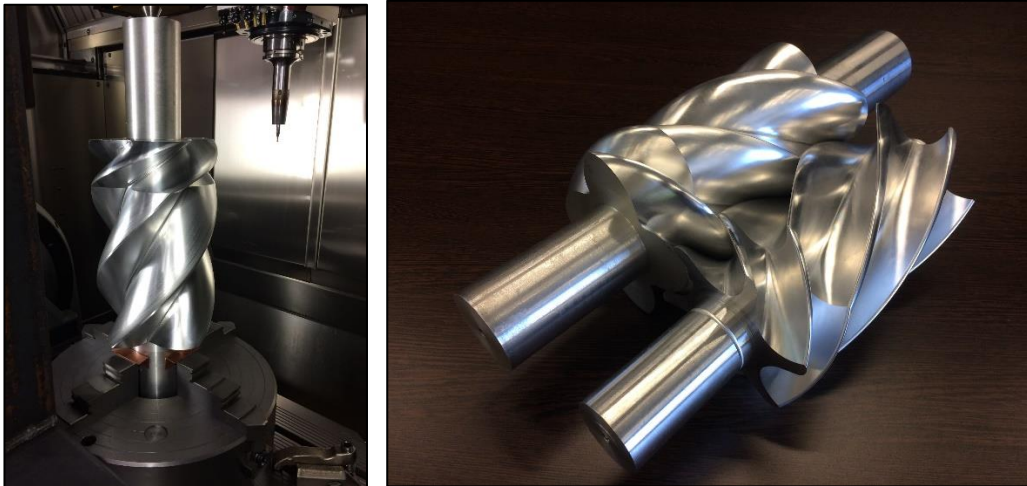
Abbildung 8.2: Dual-Lead-Hauptrotor aus Aluminium auf einer Fünffachsfräse mit eingespanntem Zwei-Millimeter-Fräswerkzeug (links), fertiges Dual-Lead-Rotorpaar aus Aluminium ohne bearbeitete Wellenabsätze (rechts) [Utr18d].
