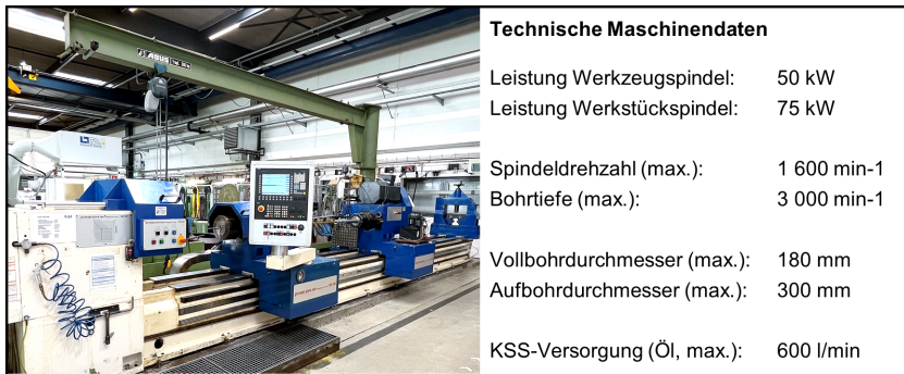
Abbildung 4.2: BTA-Tiefbohrmaschine Giana GGB560 CNC
