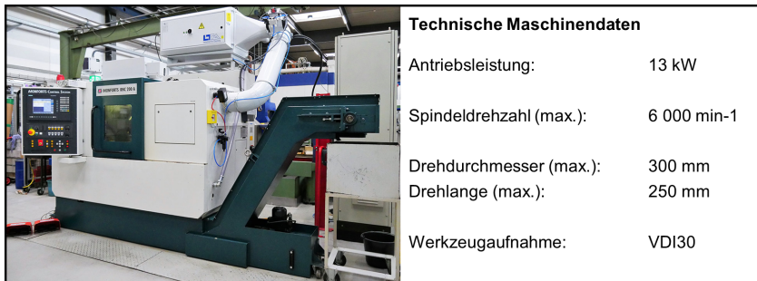
Abbildung 4.1: CNC-Drehmaschine Monforts RNC200A
