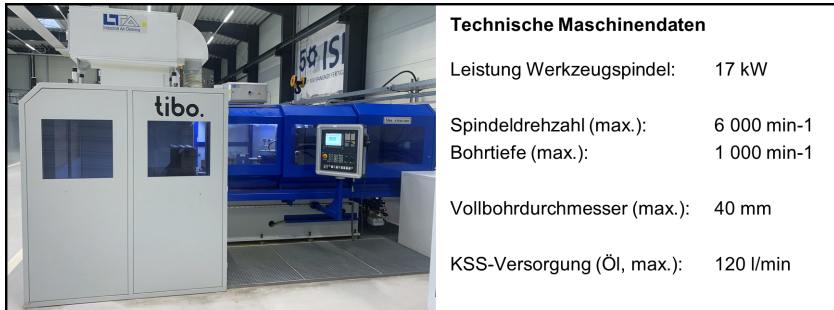
Abbildung 4.3: Koordinaten-Tiefbohrmaschine tibo KTE40-1000
