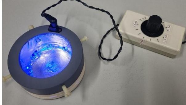
Abbildung 125: Runde Beleuchtungsapparatur für die IVT-Endpunktbestimmungen.
