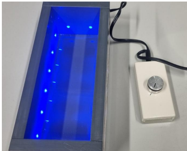
Abbildung 126: Rechteckige Beleuchtungsapparatur für die kinetische Bestimmung der Aktivitäten.
