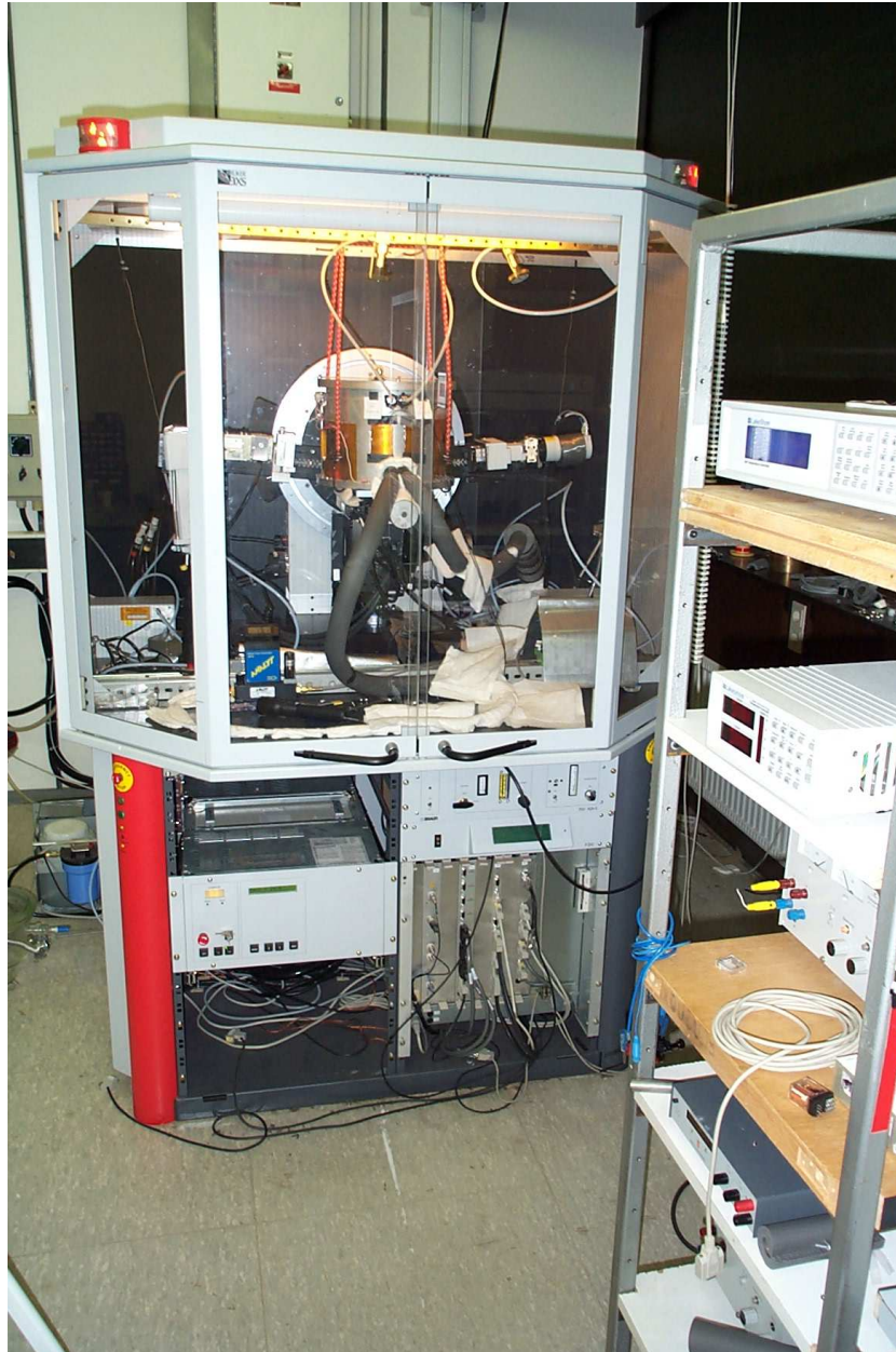
Abbildung 3.10: Das Bruker advance Labordiffraktometer (D8) mit Probenzelle. Auf der rechten Seite des Photos ist die Temperatursteuerung zu erkennen.
