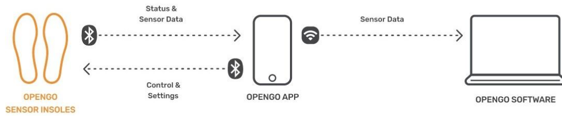
Abb. 15. Datenübertragung der Moticon OpenGo Insole3 (bereitgestellt durch Moticon ReGo AG)
