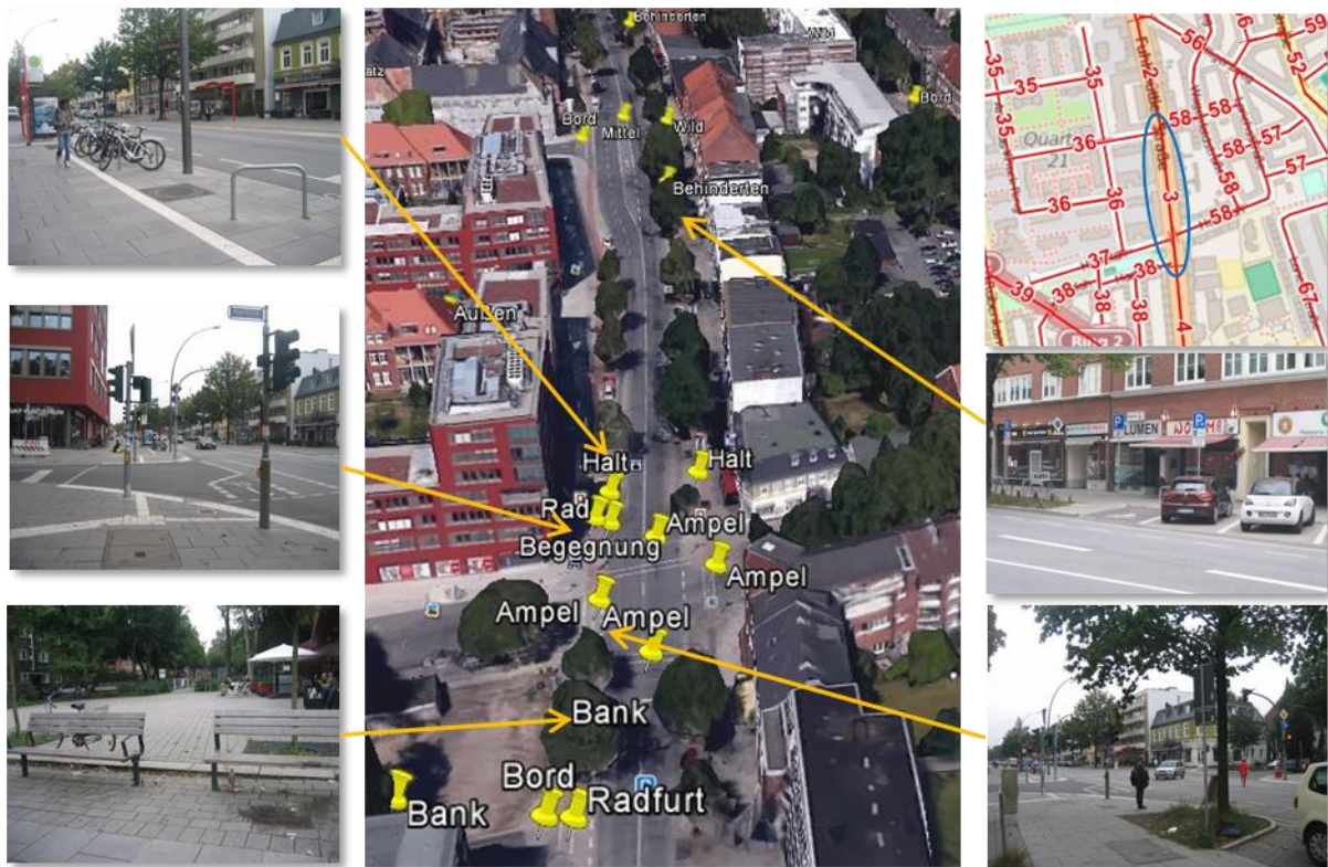
Abbildung 10: Exemplarische Darstellung der Bestandsaufnahme mit GPS-locierten Informationen und Fotodokumentation (Quelle: Planersocietät, Google Street View)
