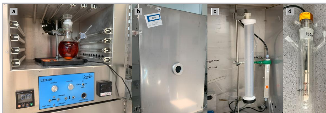
Abbildung 63: In dieser Arbeit verwendete Reaktorsysteme; Foto a , LZC-4V Photoreaktor der Firma Luzchem; Foto b , Verschließbare Hülle zum Schutz vor Strahlung; Foto c , Durchflussreaktorsystem; Foto d , Tauchreaktor mit interner Lichtquelle.
