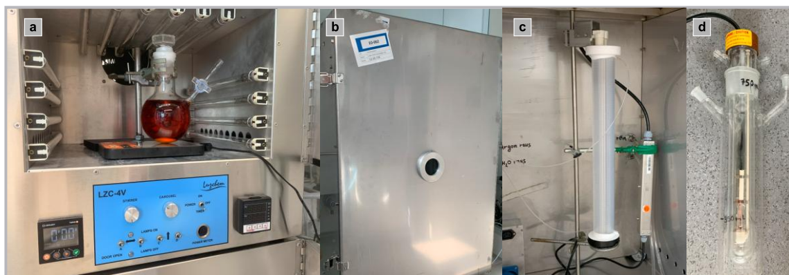
Abbildung 32: Gebräuchliche photochemische Reaktorsysteme; a , LZO-4V Photoreaktor der Firma Luzchem; b , Verschließbare Hülle zum Schutz vor Strahlung; c , Durchflussreaktorsystem; d , Tauchreaktor mit interner Lichtquelle.
