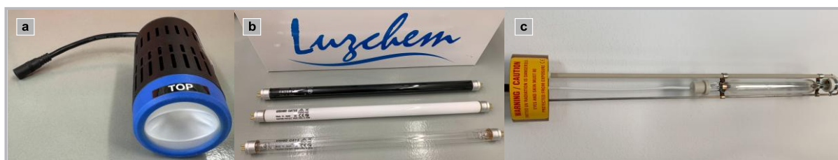
Abbildung 31: Gebräuchliche Strahlungsquellen für photochemische Reaktorsysteme; a , LED-Lampe der Firma Kessil®; b , UV-Lampen der Firma Luzchem. Oben: UV-A (367 nm) Mitte: UV-B (≈ 300 nm) Unten: UV-C (254 nm); c , 125 W Mitteldruck Quecksilberdampflampe zur Anwendung in einem Tauchreaktor der Firma Photochemical Reactors Ltd.
