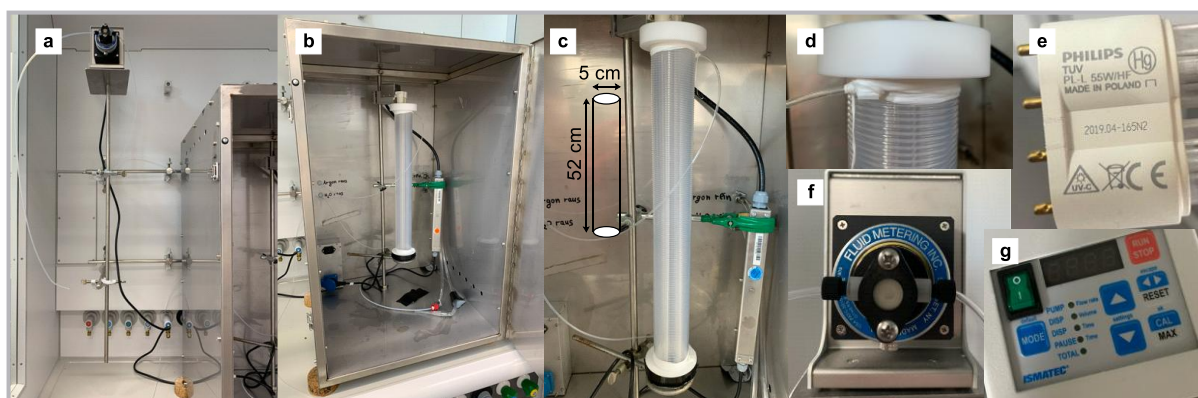
Abbildung 108: In dieser Arbeit verwendeter Durchflussreaktor. Foto a , Pumpensystem bestehend aus Drehkolbenpumpen-/Taumelkolbenantrieb und Taumelkolbenpumpenkopf; Foto b , Strahlungsschutzkasten mit Durchflussreaktor; Foto c , Durchflussreaktor bestehend aus einer Quartzglashülse, die mit einer Lage FEP-Schlauch umwickelt wurde. Fixiert werden die Quartzglashülse und der FEP-Schlauch durch zwei PTFE-Endverkappungen; Foto d , FEP-Schlauch und Schlauchführung/-fixierung in einer PTFE-Endverkappung; Foto e , Phillips TUV PL-L 55W, UVC (254 nm); Foto f , Frontansicht des verwendeten Pumpensystems; Foto g , Ansicht des Displays.
