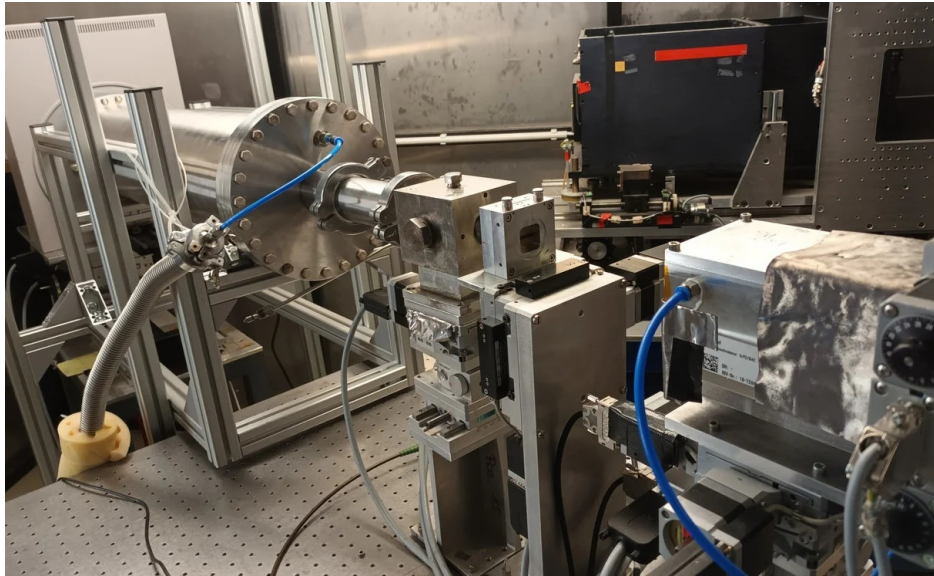
Abbildung 4.3: Messaufbau an der Strahllinie BL2 (SAXS). Zu erkennen sind der MAR345-Flächendetektor, die Justiereinheit zur exakten Ausrichtung der Hochdruckzelle im Strahl sowie die vakuuierte Röhre zur Minimierung von Streustrahlung auf dem Weg zwischen Probe und Detektor.
