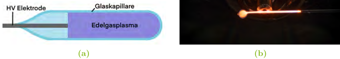
Abbildung 4.3: a) Schema eines C \mu TP und b) Foto eines C \mu TP vor einem Massenspektrometer.
