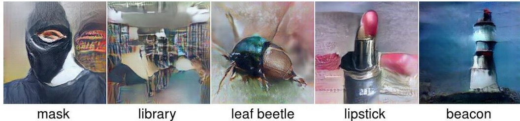
Abbildung 12.4: Feature-Visualisierungen der Output-Neuronen des CaffeNet DNN für die Bildklassen ‚Maske‘, ‚Bibliothek‘, ‚Blattkäfer‘, ‚Lippenstift‘ und ‚Leuchtturm‘, erstellt mithilfe der Methode von Nguyen et al. (2016). Bildquelle: Evolving Artificial Intelligence Lab (2020). Siehe Teil IV für Details.
