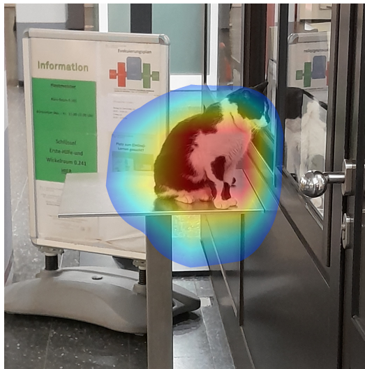
Abbildung 7.1: Grad-CAM-Erklärung für die Klassifikation eines Fotos als ‚Bobtail‘ durch das Modell ResNet-50 (50,93%). Von rot hin zu blau eingefärbten Bildbereichen nimmt der Einfluss auf die Klassifikation ab. Bildbereiche mit keinem oder geringem Einfluss auf die Klassifikation sind aus Gründen der Übersichtlichkeit nicht eingefärbt. Bildquelle: Privat / eigene Darstellung unter Verwendung von Grad-CAM (Selvaraju et al., 2017). Siehe Teil IV für Details.
