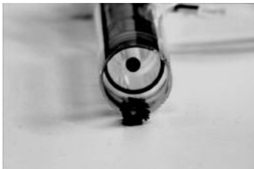
Abb. 70: Rußablagerungen an der ICP-Torch nach einem Betrieb von 30 min im Falle der Zerstäubung eines Gemisches von 67% Acetonitril und 33% Wasser unter Verwendung einer Desolvatisierung
