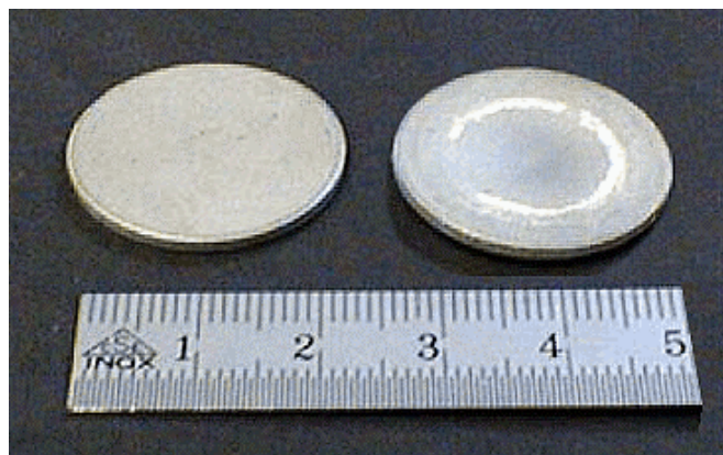
Abb. 56: Neue Edelstahlfritte (1" Ø, 0,5 µm Porenweite) für die modifizierte Extraktionssäule (links) und Edelstahlfritte nach 15 Extraktionen (rechts)
