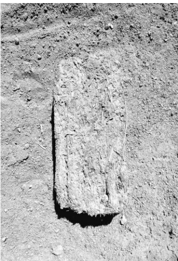
Abb. 4_3_001: Lehmstein zum Einsatz beim Wiederaufbau bzw. bei der Sanierung vorhandener Lehmbauten in New Qurna
