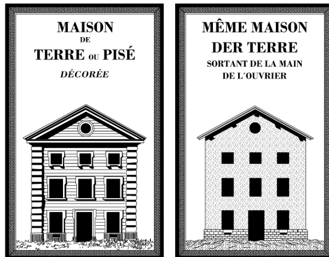
Abb. 2_1_4_010: Darstellung diverser Lehmbautechniken gem. Cointereaux („Der Lehm- oder die Pisé-Baukunst“), Darstellung des Autors nach: [Dethier, 1982]
