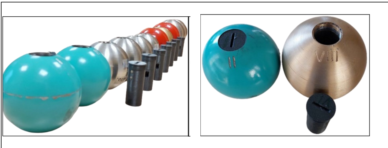
Abb. 1. Links: Hergestellte Kugeln mit Sensorik (Gehäuse). Rechts: Kugel mit und ohne eingedrehtem Sensorgehäuse.
