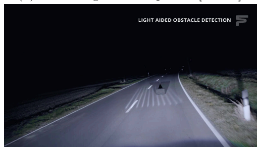
(d) Structured light projection [Kub+14; For23a].
