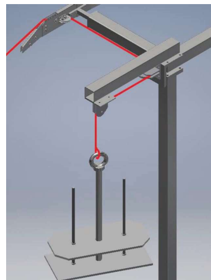
Abbildung 4.12: Seilverlauf an Schienelement Umlenkung und Gewichte-Halterung [Woh20]
