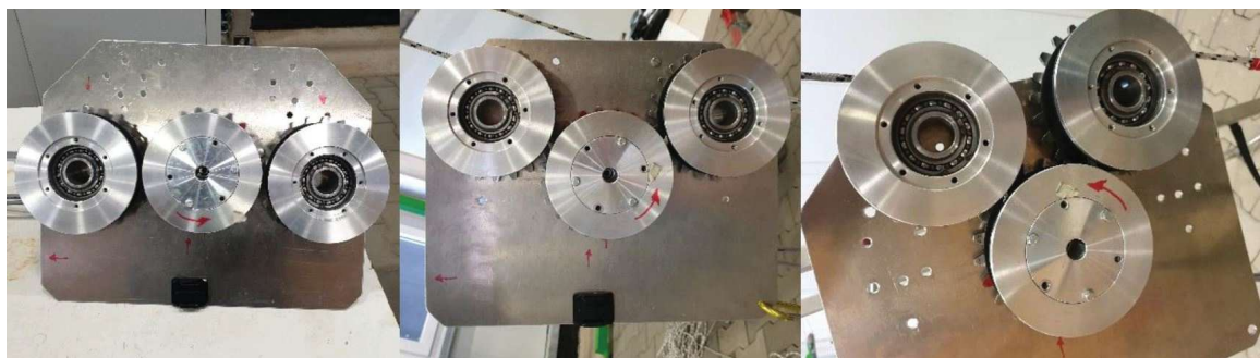
Abbildung 6.7: Umschlingungswinkel 60°, 120° und 180° v.l.n.r. [Höl20]
