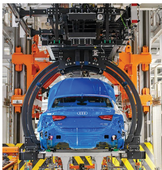
Abbildung 2.18: Elektrohängebahn mit bis zu 10.000 kg Nutzlast [Rof23]
