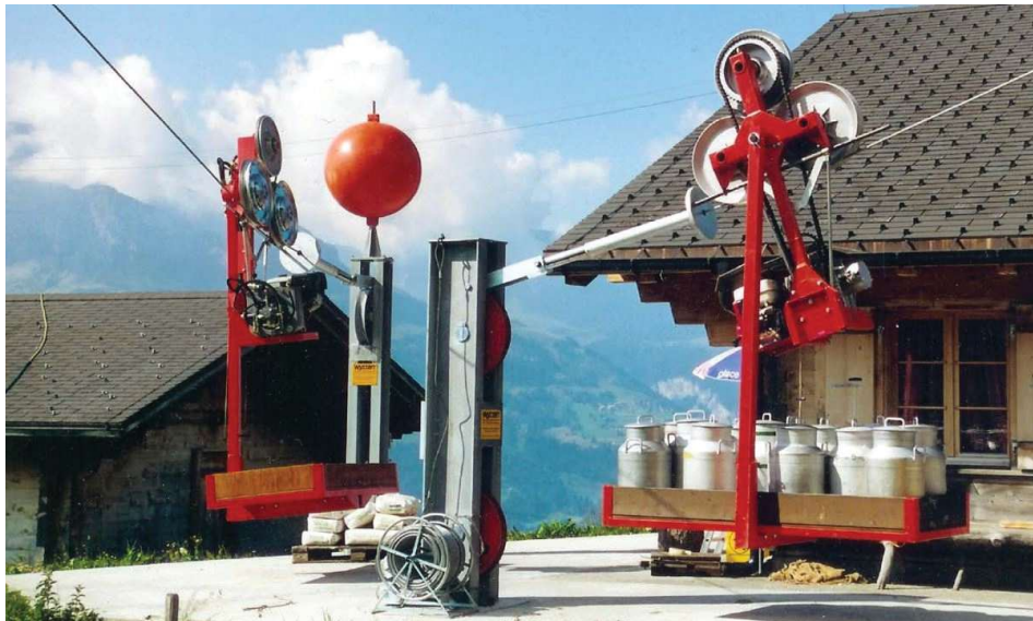
Abbildung 2.22: Wyssen Einseilbahn [Wys23]
