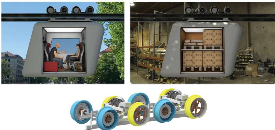
Abbildung 2.13: Ottobahn: links u. rechts Personen- u. Gütertransport; Mitte: Fahrgestell [Ott23]
