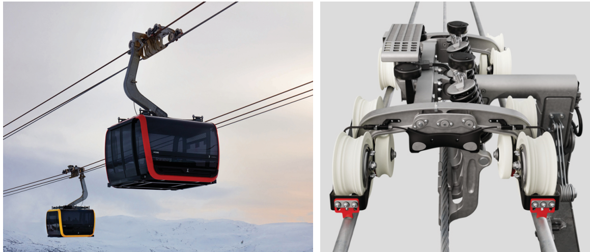
Abbildung 2.25: Dreiseilumlaufbahn der Firma Leitner und Laufwerk [Lei24]
