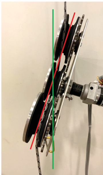
Abbildung 6.15: Schräglage der Seilbahn bei zu geringer Seilvorspannung
