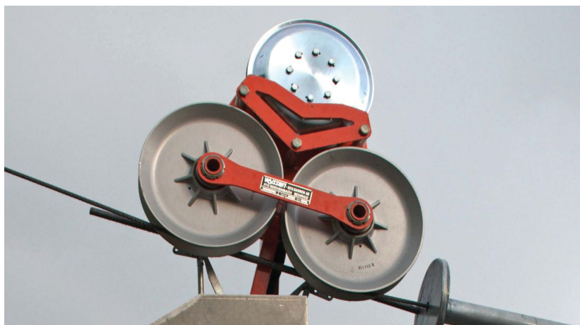
Abbildung 2.23: Seilführung bei der Wyssen Einseilbahn [Wys23]
