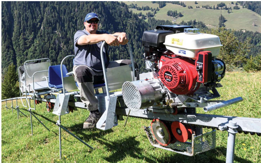
Abbildung 2.14: Doppelmayr Benzin-Monorack [Dop23]
