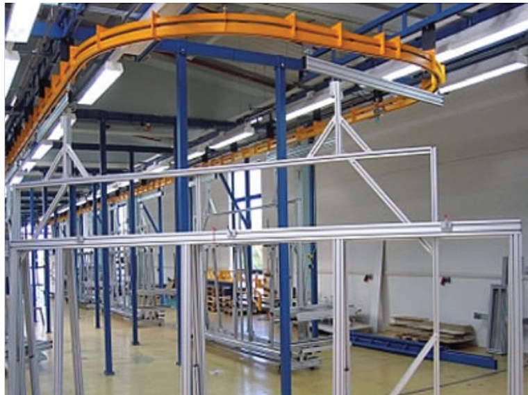
Abbildung 2.20: Power & Free Systeme von GPI [Gpi22b]
