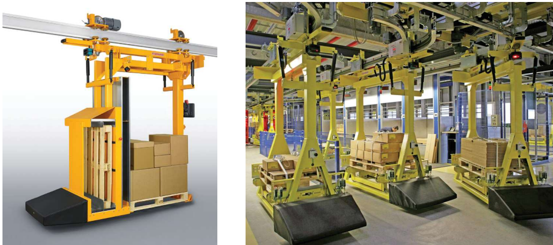
Abbildung 2.4: Elektrohängebahn der Firma Eisenmann [Wik13], [Eis09]
