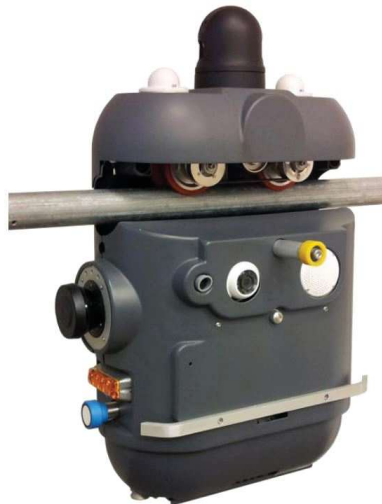
Abbildung 2.16: „Roboter“ (Laufkatze) des Systems Magal Security RoboGuard [Mag22]
