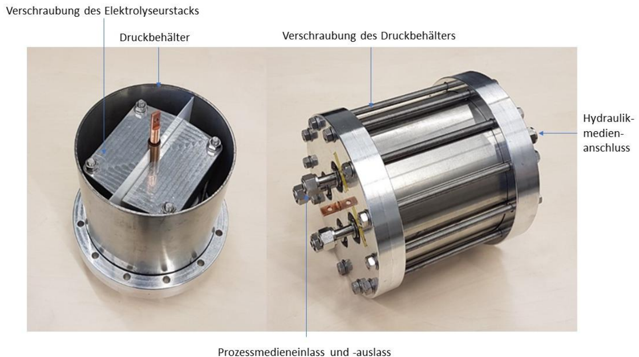
Abbildung 6: PEM-Elektrolyse-Stapel mit verstärktem Druckgehäuse. (Quelle: Westfälisches Energieinstitut)
