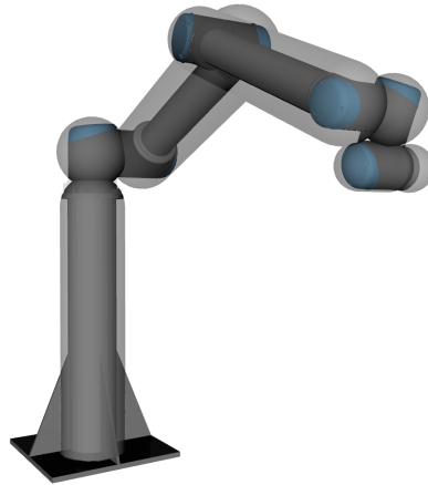
Abbildung A.2.: Hüllkörper (grau durchsichtig) am UR10.
