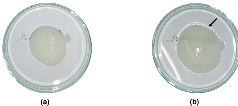
Abbildung 9.2: Foto des Fettes S1a-1.1 (a) vor und (b) nach dem Tempern nach standardisiertem Verfahren. Der Pfeil kennzeichnet die Ölabscheidung des Fettes durch die Temperaturbehandlung.
