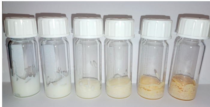
Abbildung 11.14: Fett C1a-H ungetempert sowie nach Tempern bei 50, 75, 100, 125 und 150°C (von links nach rechts).
