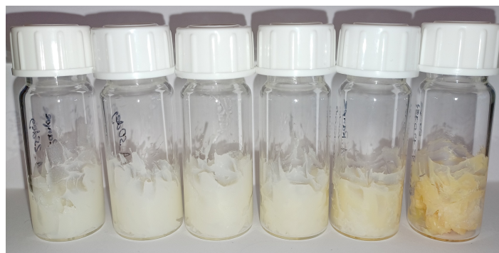
Abbildung 3.13: L1a-H, bestehend aus 20 Gew.-% in-situ polymerisiertem Verdicker aus 1,5-Diaminopentan, PDI und Stearylamin ( \bar{P}_n = 3,6 ) in Ricinusöl, vor und nach Tempern bei 50, 75, 100, 125 und 150 °C (v. l. n. r.).
