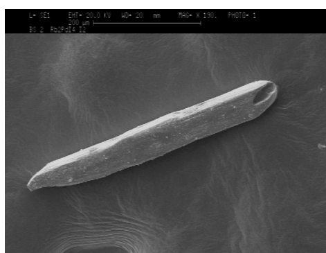
Abb. 173: Rasterelektronenmikroskopische Aufnahme eines Kristalls von \text{Rb}_2\text{PdI}_4 \cdot \text{I}_2
