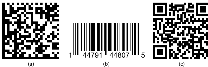
Abb. 2.7 Beispiele extrinsischer Kodierungen: DataMatrix (a), UPC-A (b) und QR (c).
