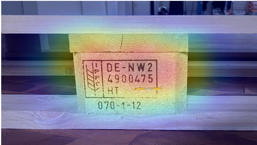
Abb. 2.12 Visualisierung der entscheidenden Features eines Klassifikationsmodells als Attention Heatmap (basierend auf dem letzten Convolutional Layer des Modells ResNet50, visualisiert mittels Grad-CAM [Sel+17]).
