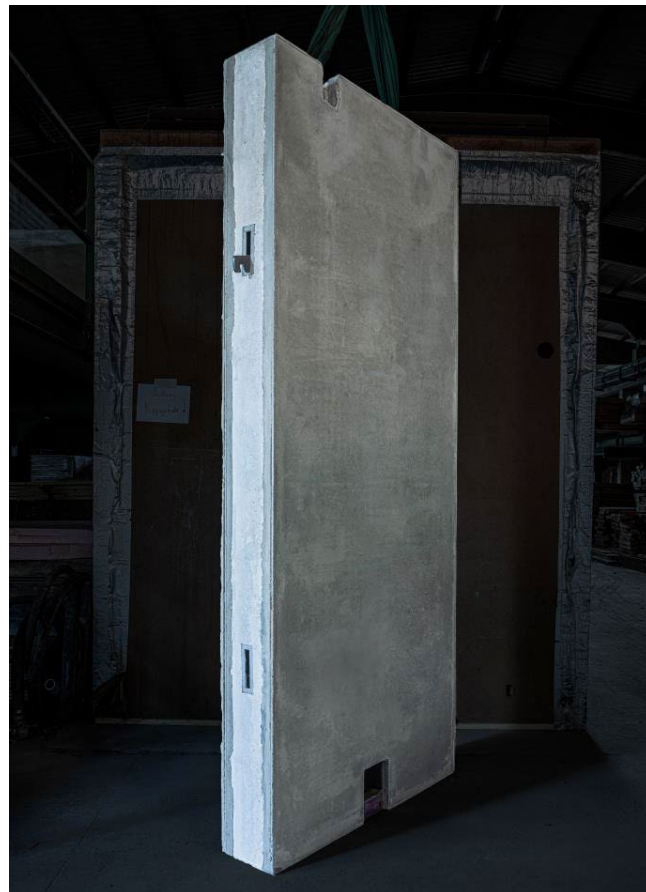
Abb. 72: Demonstrator der Gradientenbetonwand © ILEK
