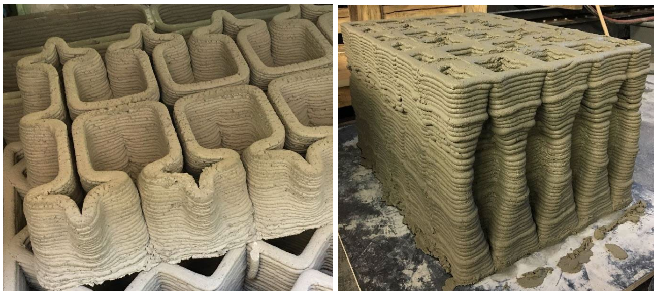
Abb. 10: Wandkonstruktion aus spezifischen 3-D gedruckten Geometrien mit geschlossenen Hohlräumen © Klaudius Henke
