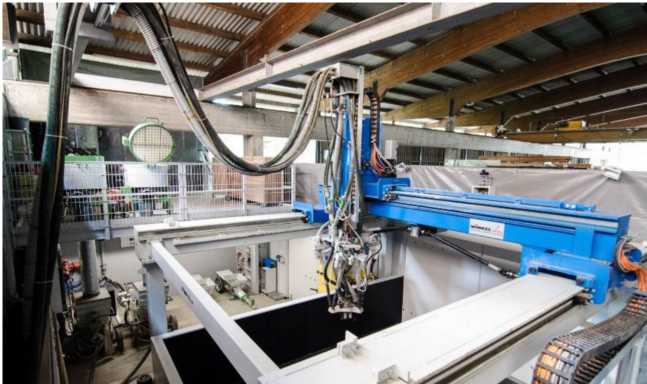
Abb. 64: Applikationssystem mit Stewart-Gough-Plattform © ILEK 528
