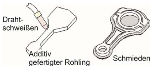
Bild 2.10: Additive Herstellung eines Schmiederohlings (Silva et al., 2017)
