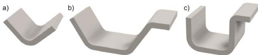
Bild 7.22: Durch das Gesenkbiegen herstellbare Bauteile, a) V-Profil, b) Trapezprofil, c) U-Profil, b) und c) jeweils mit und ohne Flansch
