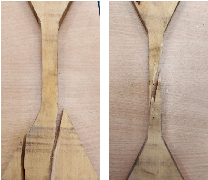
Abbildung 52: Prüfkörper im Zugversuch nach dem Versagen
