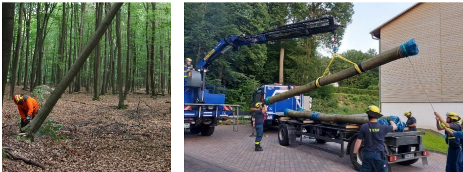
Abbildung 23: Links: Fällung der Bäume für Versuchskörper. Rechts: Verladung für den Transport mit textilen Schlingen und Gummimatten.
