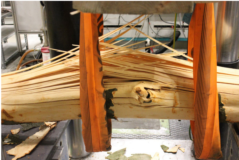
Abbildung 37: Faserbündeldelamination und Aufreißen am Astansatz des oberen Abschnittes von Baum 5.
