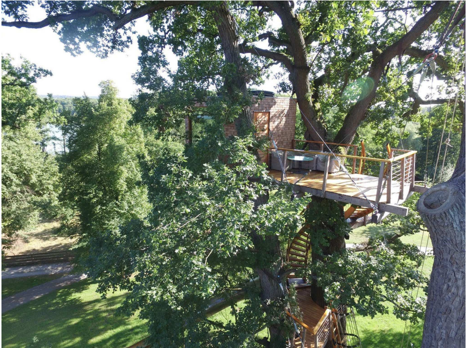
Abbildung 16: Redundante Verseilung eines Baukörpers im Kronenbereich von Eichen.
