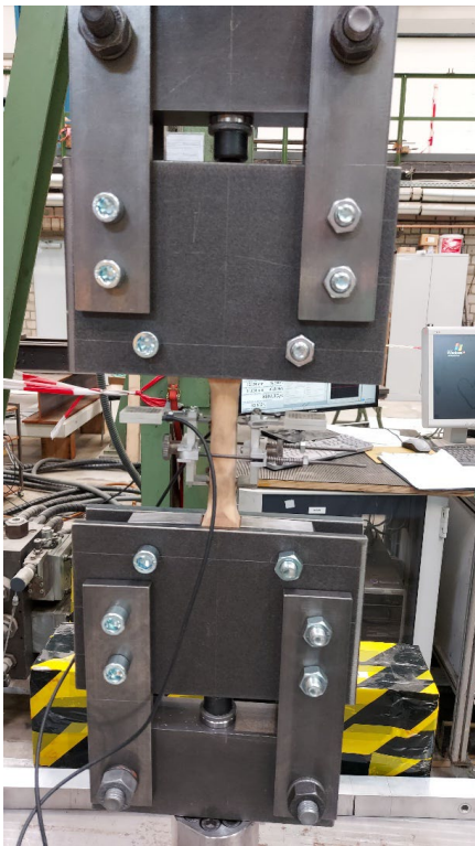
Abbildung 49: Modifizierter Zugprüfkörper mit Dehnungsmesseinrichtung und Konstruktionszeichnung.
