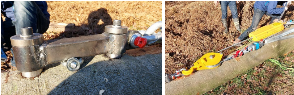
Abbildung 106: Realer Belastungsversuch des Anschlusses unter \alpha=90^\circ .
