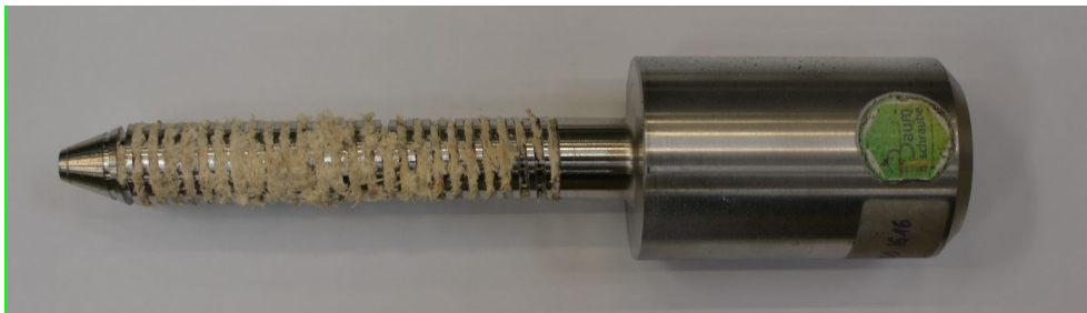
Abbildung 79: Baumschraube nach dem axialen Ausziehversuch
