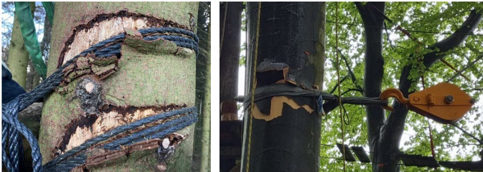
Abbildung 63: Abrutschen reibungsbasierter Verbindungen nach Kategorie 2, welche durch den Aufbau von Formschluss an Asterhebungen (links) bzw. durch die Neuausrichtung des Lastseils zum Stillstand kommt (rechts).
