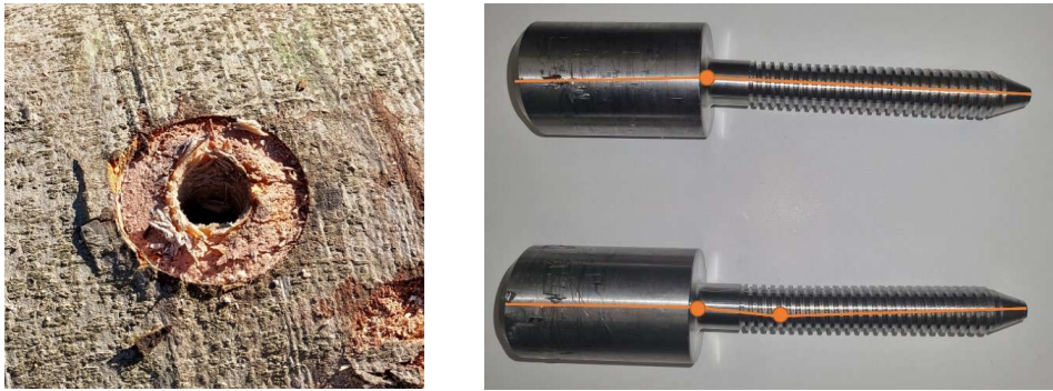
Abbildung 108: Bohrloch nach Entfernung der unteren Schraube (links) sowie verformte Baumschrauben nach dem Belastungsversuch mit Mittelachsen und Markierung von Bereichen hoher Krümmung durch überhöhte Linien mit Punkten (rechts).
