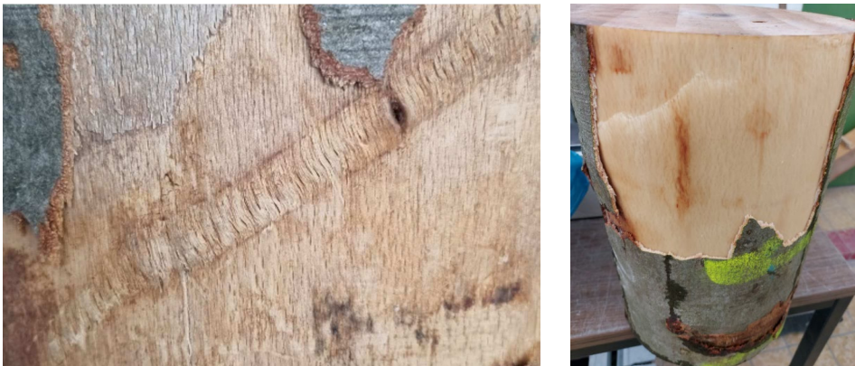
Abbildung 44: Ausbildung eines Scherbandes mit lokalem Faserknicken (links) und radiales Ausknicken von Jahrringschichten (rechts).
