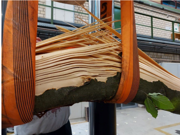
Abbildung 34: Typisches Versagensbild des Querschnittes im Biegeversuch.
