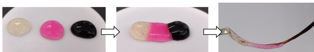
Abbildung 33: Visualisierung der selbstheilenden Eigenschaften der thiolactonhaltigen Wirt-Gast-Hydrogele am Beispiel von Hydrogel Gn8 , welches in Originalfarbe, rot eingefärbt und schwarz eingefärbt hergestellt, dann zusammengeschoben und nach der Selbstheilung auseinandergezogen wurde.
