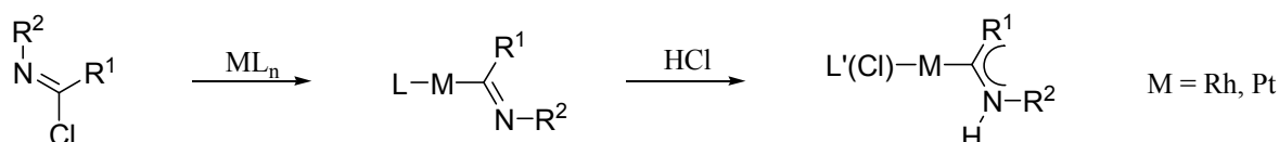
Schema 31: Oxidative Addition von Imidoylchloriden an Rh- und Pt-Vorläufer und anschließende Protonierung. [118, 125-128]
