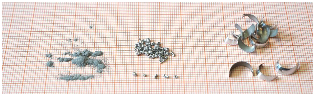
a) Aluminium: Puder (<100 µm), Granulat (0,5...1,5) mm, Späne
