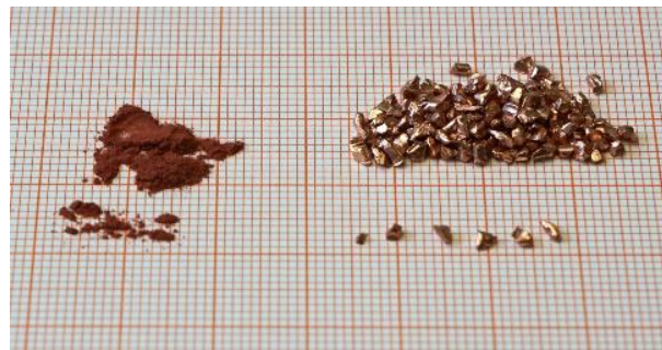
b) Kupfer: Puder ( <38\ \mu\text{m} ), Granulat (1,6...1,8) mm
