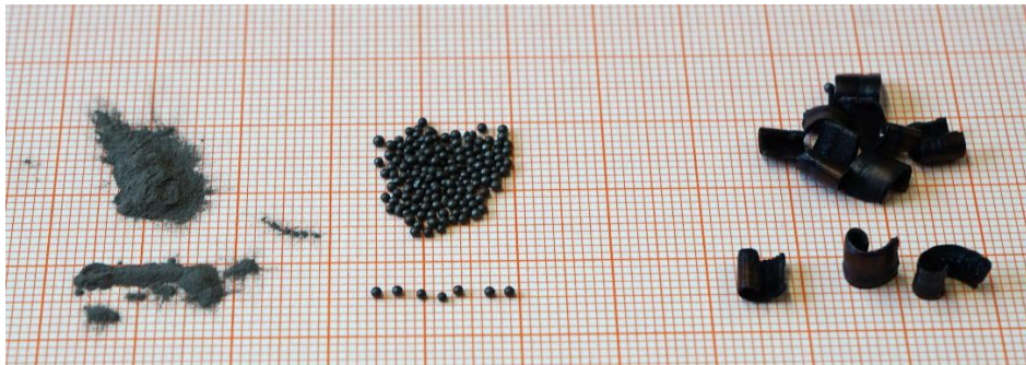
c) Eisen: Puder ( <30\ \mu\text{m} ), Granulat (0,9...1,2) mm, Späne
