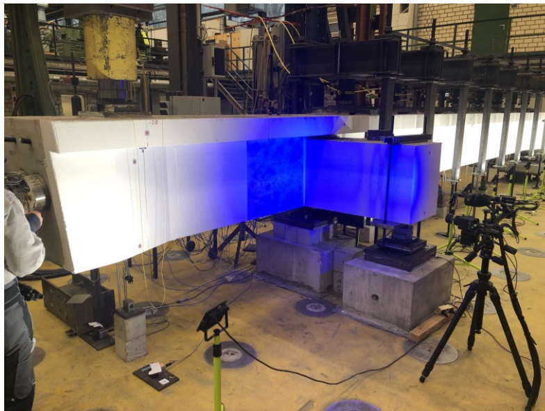
Abbildung 3-12: Übersicht über die photogrammetrische Messung am Beispiel von ETK2
