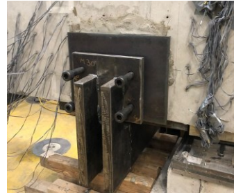
Abbildung 3-9: Druckzonenumschließung zur Vermeidung der vorzeitigen Betonabplatzung im Druckbereich ETK2 bis ETK5
