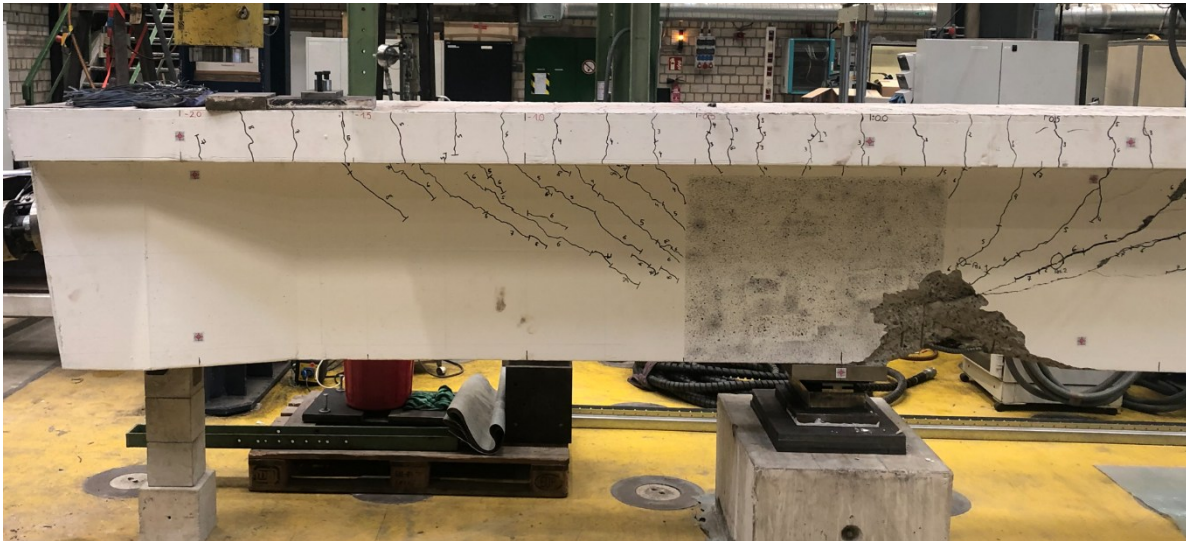
Abbildung 5-1: Sekundäres Betonversagen in der Druckzone ETK1
