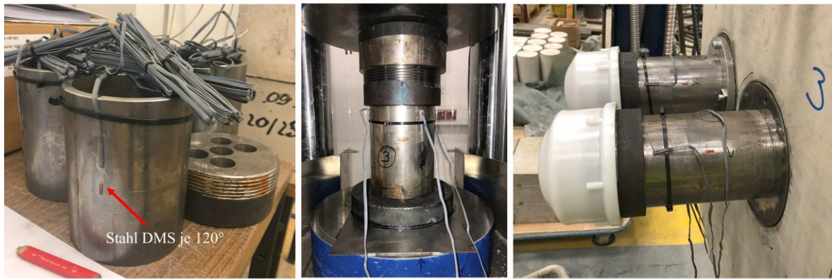
Abbildung A 3-14: nicht wiederverwendbare Kraftmessdosen aus Stahlrohr 116x8,8
