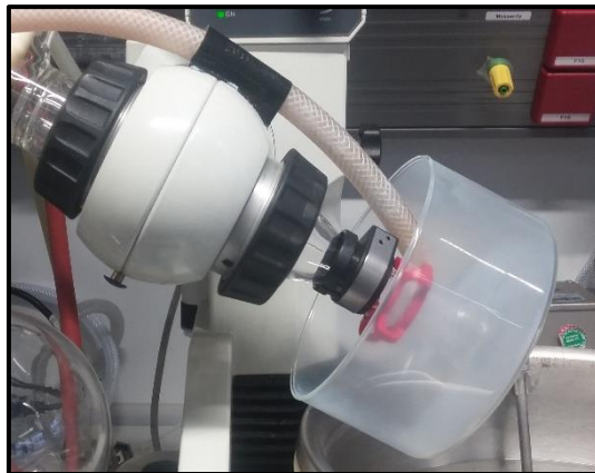
Abbildung 4.2.12: Kopfteil der Apparatur in Form eines umfunktionierten Rotationsverdampfers.
