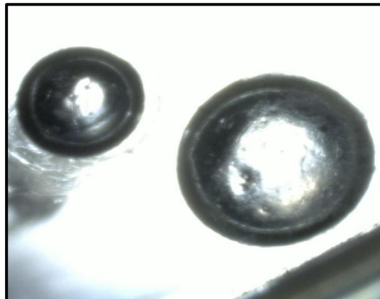
Abbildung 4.2.2: Lichtmikroskopiebild der ersten erfolgreich synthetisierten Mikrobalkons in einer Wasserphase.
