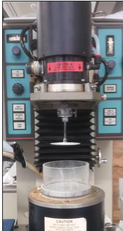
Abbildung 3.2.2: Rheometrics Fluid Spectrometer mit Reaktionsgefäß und Messtempel.
