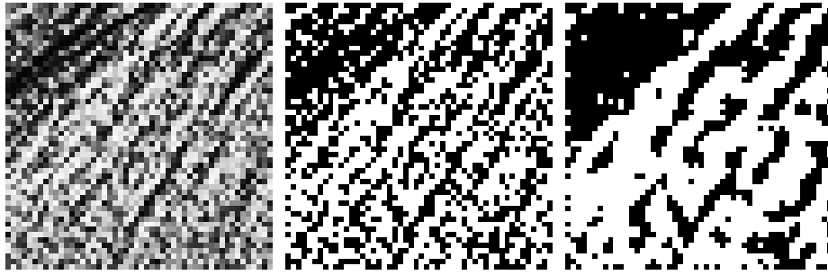
Abbildung 5.6: Korrelationskoeffizienten: Grauwerte, binarisiert und Median-gefiltert (3x3)
