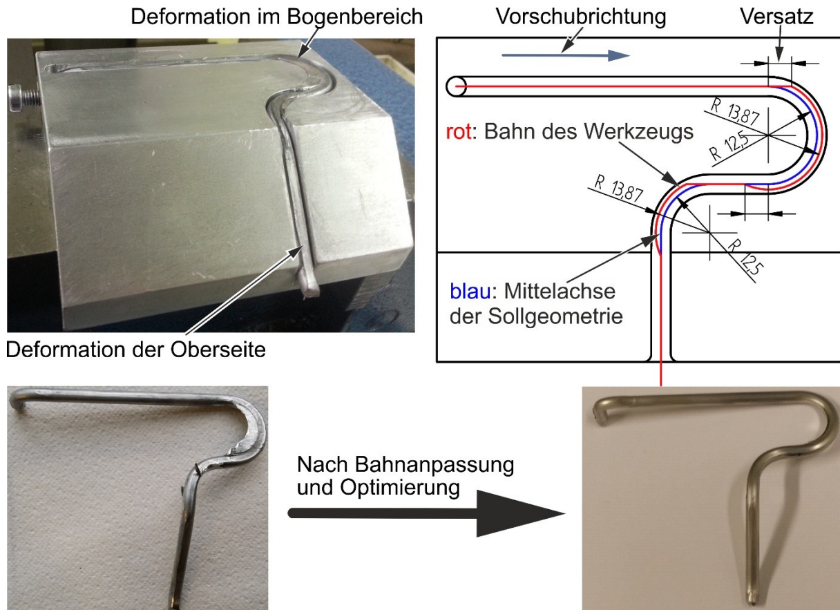
Bild 4.3: Experimentelle Ergebnisse vor und nach Bahnanpassung und Optimierung
