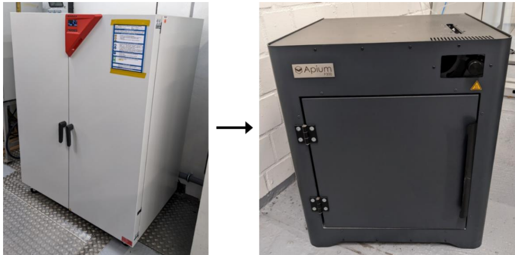
Abbildung 5.59: Geräte zur Konditionierung des thermoplastischen Kunststoffes; links: Klimaschrank des Herstellers Binder; rechts: Vorwärmmodul der Firma Apium
