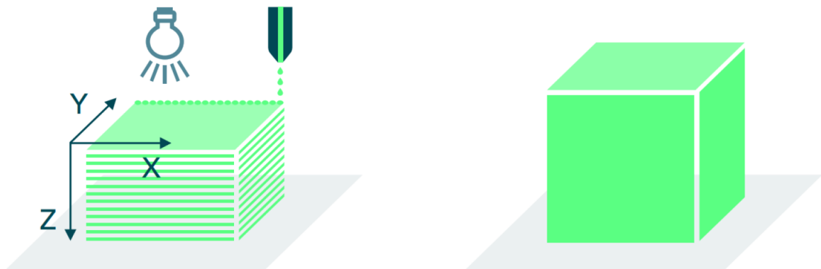
Abbildung 2.21: Verfahrnsprinzip der Drop-on-Demand-Technologie von ACEO®; links: tröpfchenweise Erzeugung der Einzelschichten; rechts: vernetztes Formteil unter schichtweiser Vulkanisation [WAC 20b]
