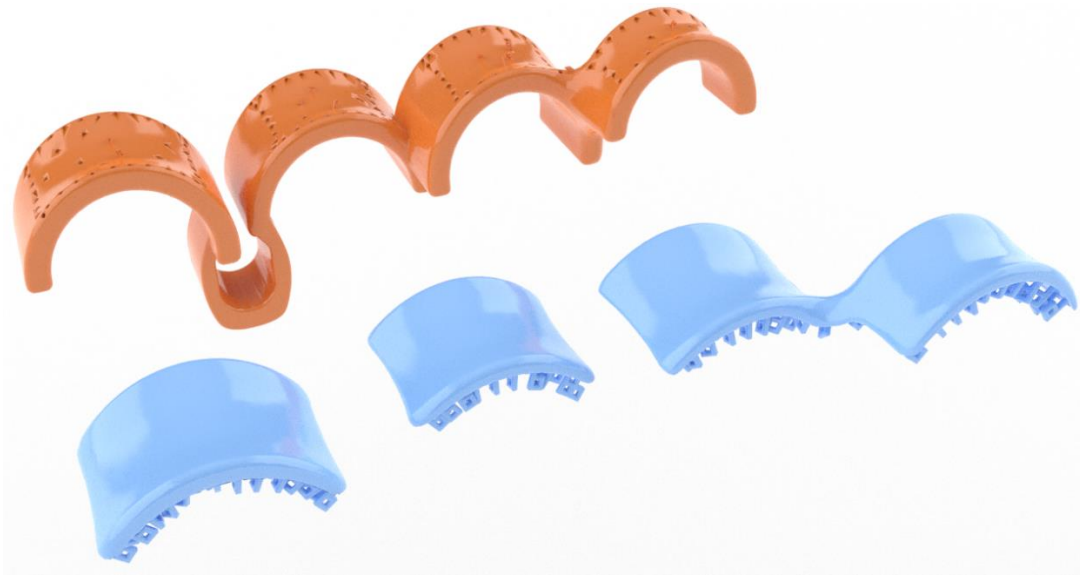
Abbildung 5.11: Teilmodelle des Hybridprodukts mit den ausgeschnittenen (orange) sowie den hinzugefügten Verbindern (blau)
