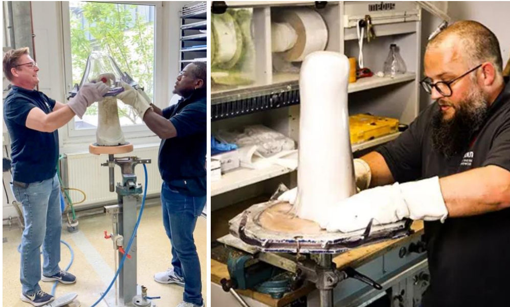
Abbildung 2.5: Manuelle Herstellung des Schafts einer Interimsprothese – Positionierung des heißen Halbzeugs über einem Gipspositiv (links) [RAH 24]; Nutzung eines Vakuums zur Formgebung (rechts) [BOR 21]
