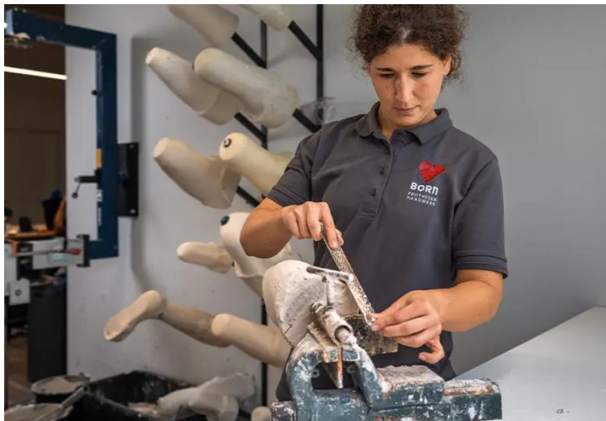
Abbildung 2.4: Manuelle Erstellung des Positivs eines Beinstumpfes im Rahmen der konventionellen Prothesenfertigung [BOR 21]
