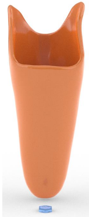
Abbildung 5.57: Modellierte Teilobjekte des individuellen WWIT; oben: Grundkörper; unten: Verdrehsicherung
