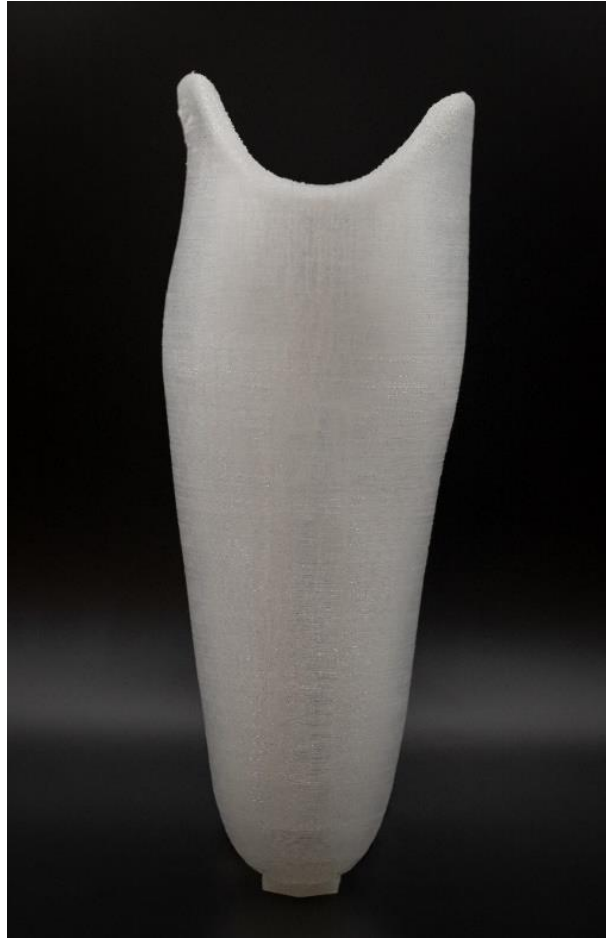
Abbildung 5.62: 3D-gedruckter individueller Weichwandinnentrichter bestehend aus LSR und PA12
