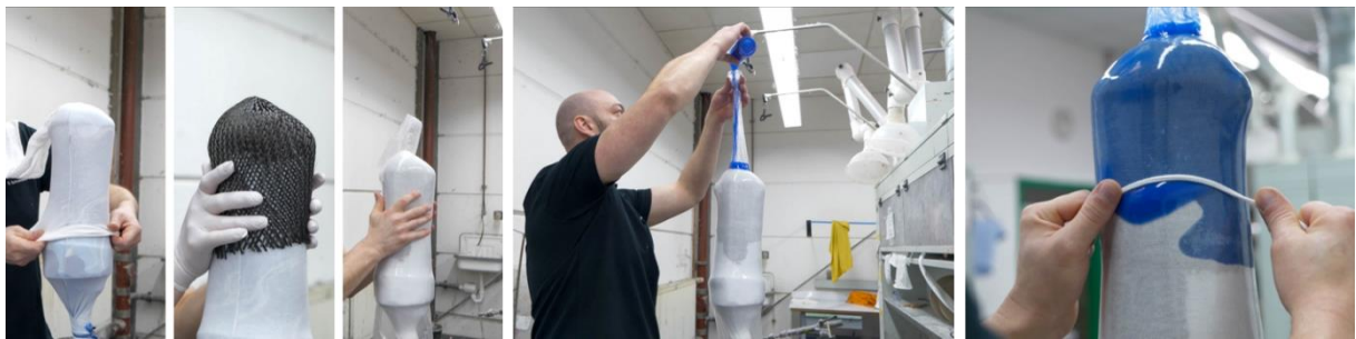
Abbildung 2.6: Konventionelle Schaftherstellung; v.l.n.r.: Einkleiden des Stumpfpositivs mit Carbonfasermatten; Einfüllen des Harzes; gleichmäßige Verteilung des Gießharzes [RAH 24]
