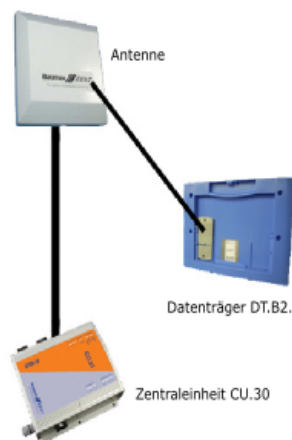
Abbildung 4.5: Komponenten der RFID-Anlage
