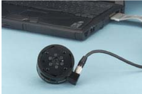
Abbildung 4.9: 6-Achsen Kraft-/Momentensensor [ATI]
