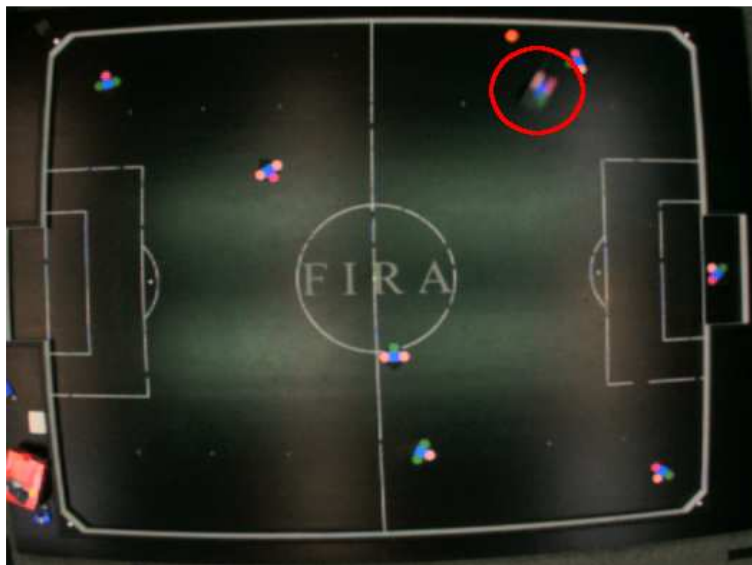
Abbildung IV.4-13 Verwischung bei niedrigem Shutterwert
