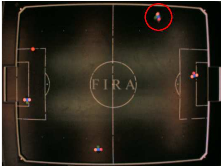
Abbildung IV.4-12 Verwischung bei hohem Shutterwert
