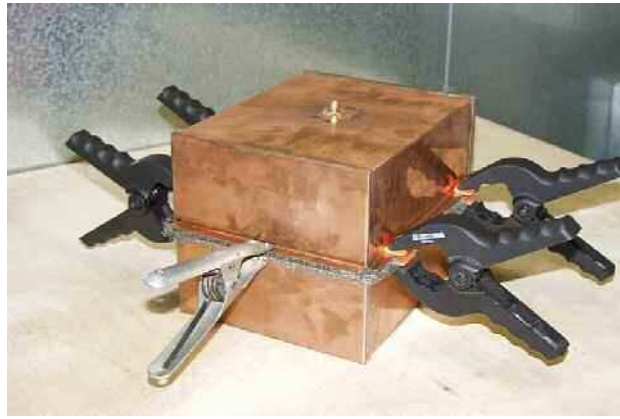
Abbildung 2.19: Kleinresonator zur Untersuchung des Einflusses der Einzelblechverbindung auf die Güte bei Verwendung der Klemmtechnik.
