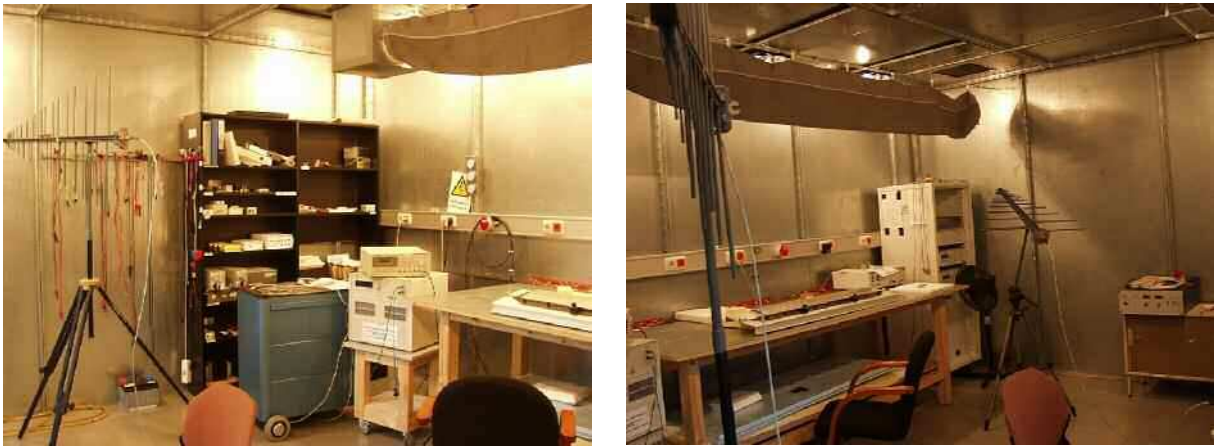
Abbildung 3.7: EMV-Schirmkabine zur Untersuchung der leitungsgeführten Störfestigkeit- und Emission von Kfz-Bordnetzkomponenten (EMV I). Die Güteuntersuchung wird ohne Veränderung oder Reduzierung der Ausstattung durchgeführt.
