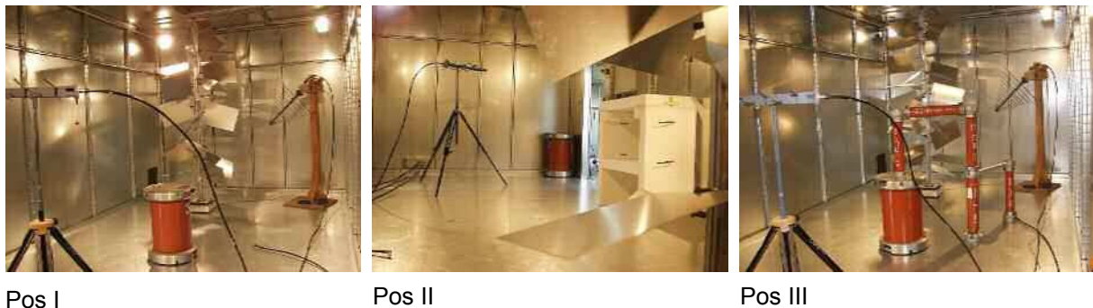
Abbildung 3.1: Unterschiedliche Aufbauten zur Untersuchung des Einflusses hochspannungstechnischer Geräte auf die Güte einer Modenverwirbelungskammer.
