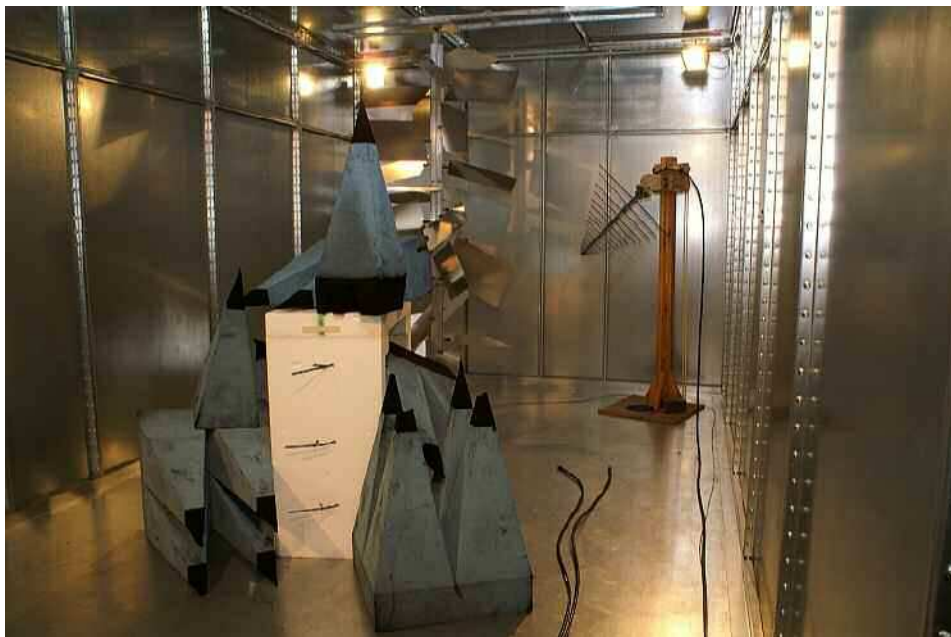
Abbildung 3.12: Beladung der Modenverwirbelungskammer am LS HSE zur Überprüfung der Feldhomogenität bedämpfter Labore.
