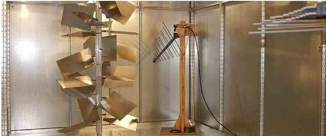
Abbildung 1.5: Asymmetrischer Modenrührer sowie Sende- und Empfangsantenne in der MVK HSE.
