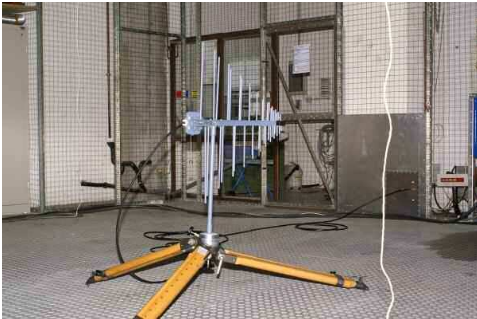
Abbildung 3.17: Vertikal polarisierte, logarithmisch-periodische Antenne mit angeschlossenem Koaxialkabel auf einer Höhe von 85 cm unter der Elektrode des Hochspannungsaufbaus aus Abbildung 3.15.
