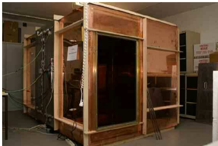
Abbildung 2.22: Modenverwirbelungskammer am Lehrstuhl für Hochfrequenztechnik der Technischen Universität Dortmund. Die an der Außenseite angebrachten Holzverstrebrungen sind aus Stabilitätsgründen notwendig.
