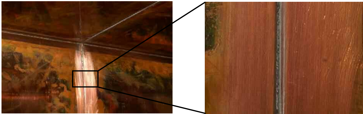
Abbildung 2.23: Verlötete Einzelblechverbindungen in der Kammer am HFT. Es ergibt sich eine nahezu plane Kammerwandinnenseite.
