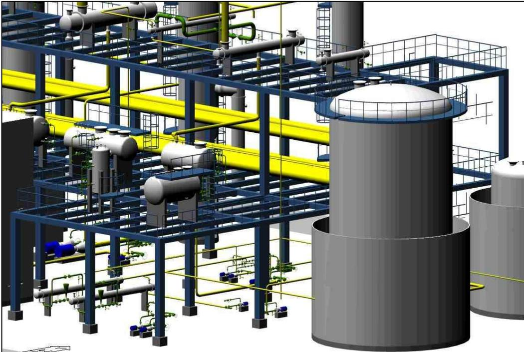
**Abbildung 3.12:** Anlagenausschnitt in der AutoCAD Visualisierung
