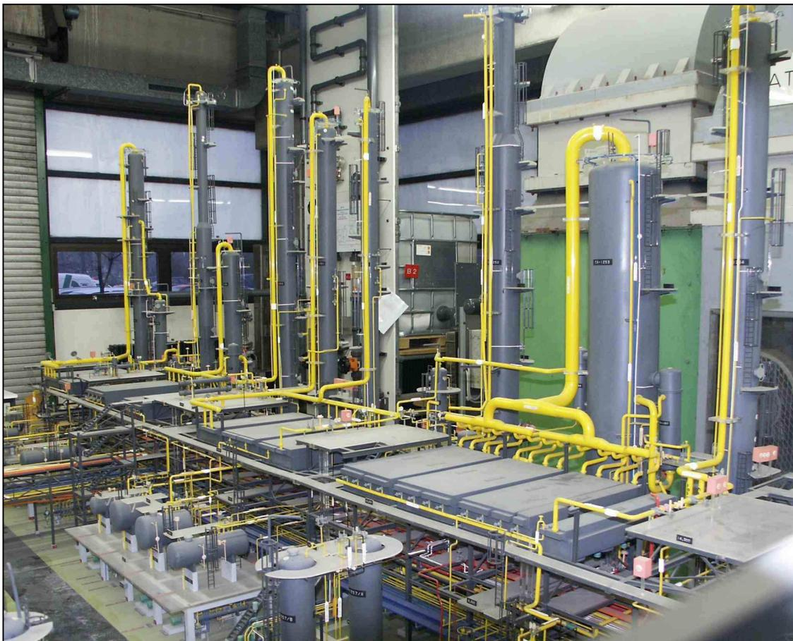
**Abbildung 6.22:** Anlage zur Aromatentrennung als Plastikmodell
