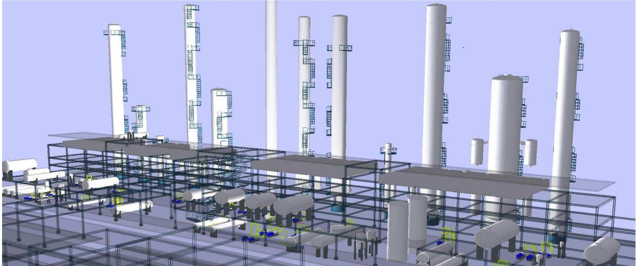
**Abbildung 6.21:** Ausschnitt aus dem Review der Aromatenanlage. Im Vordergrund der Stahlbau mit Behältern und Wärmetauschern, im Hintergrund die 11 Kolonnen
