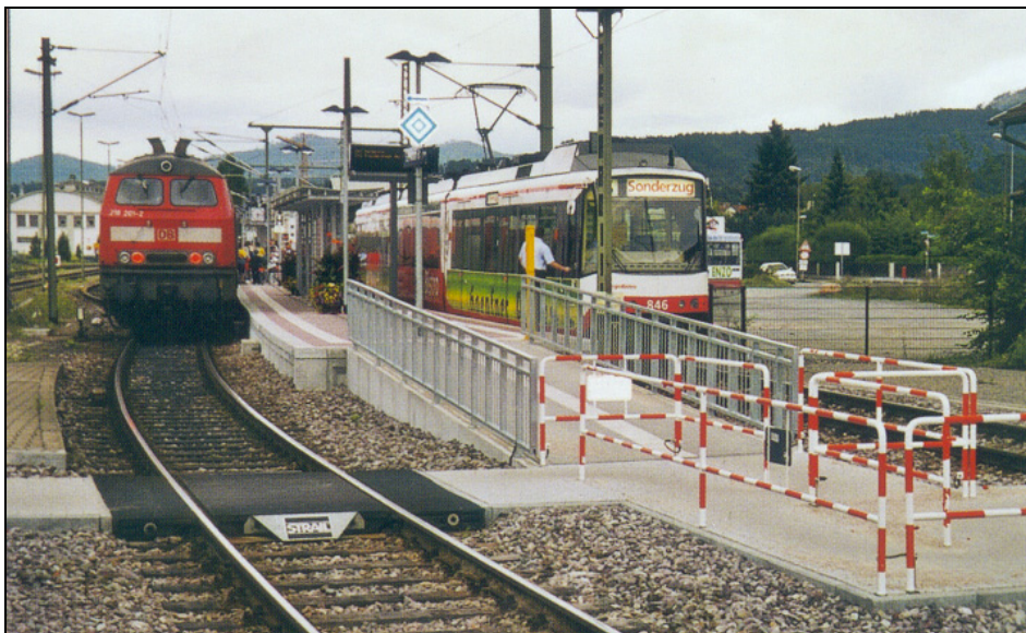
Abb. 37: Beispiel für eine niveaugleiche Gleisquerung am Bahnsteigzugang
