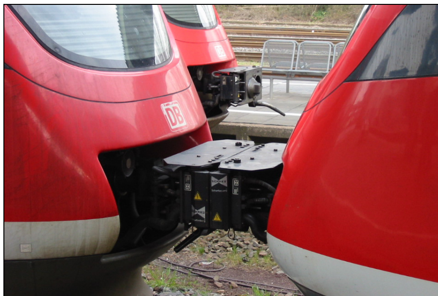
Abb. 18: Automatische Kupplung an Triebfahrzeugen vom Typ Talent zur Bildung von Zugverbänden
