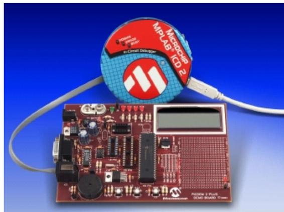
Abbildung A.10: Das PICDEM2 Plus und der ICD2 [Micc]
