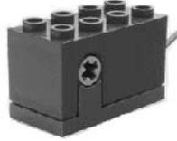
Abbildung 2.9: Rotationssensor von LEGO
