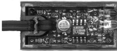
Abbildung 2.7: geöffneter LEGO-Lichtsensord
