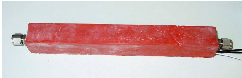
Abbildung 9: Beheizte Multikapillarsäule, eingebettet in Polymermaterial
