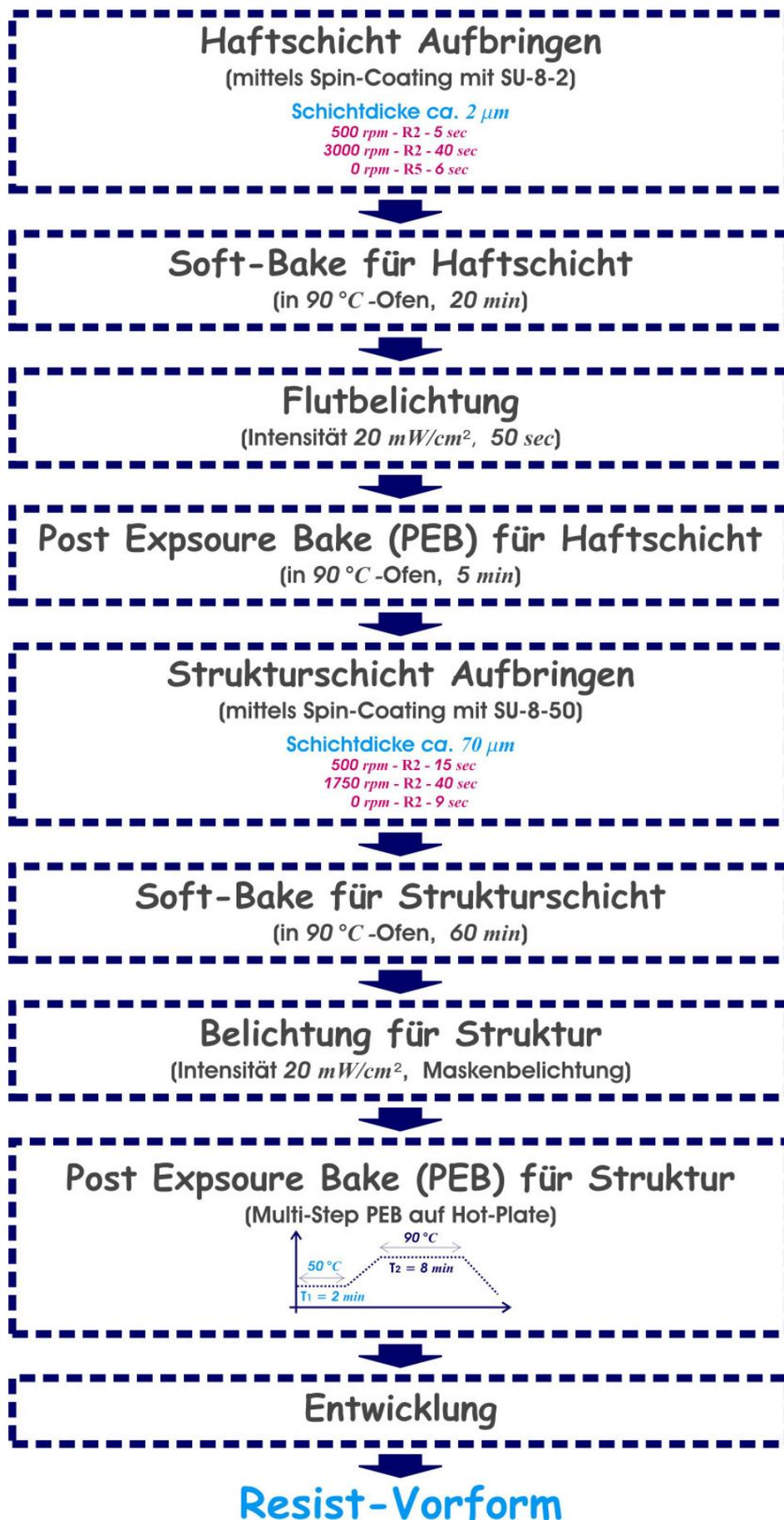
Abb.5-3 Ablauf des Herstellungsprozesses einer Resist-Vorform
