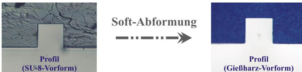
Abb.5-9 Profil von SU-8 (links) und Profil von Gießharz (rechts) nach Soft-Abformung
