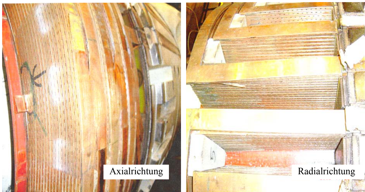
Bild 4.21: Gebrochene Polwicklung im Wickelkopf
