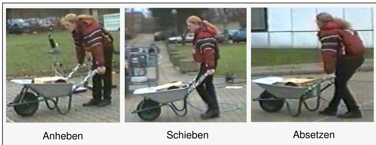
Abbildung 5-10: Videodokumentation der Körperhaltung beim Lastentransport mit der Schubkarre (exemplarisch für die Ausführung: Ebene, 60 kg, mittelschnell)
