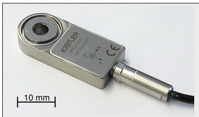
Abbildung 2-11: Piezoelektrischer 3d-Kraftaufnehmer Typ Kistler 9062A3201 mit integriertem Ladungsverstärker
