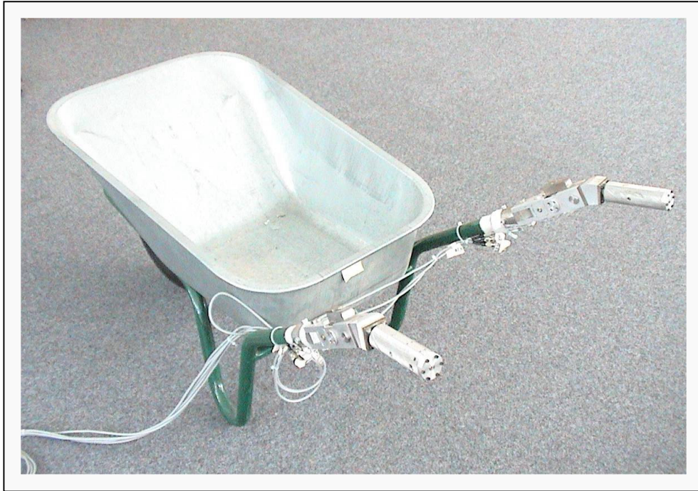
Abbildung 2-13: Schubkarre mit den an Stelle der Holme eingebauten Kraftmesseinrichtungen
