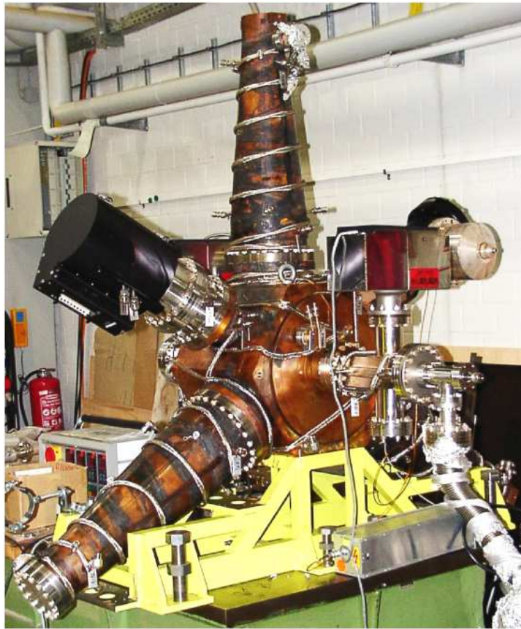
Abbildung 7.3: Foto des modengedämpften EU-Resonators
